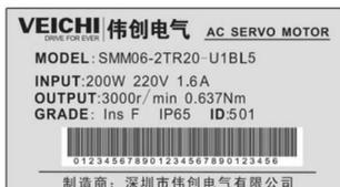
注意: 电机铭牌中的 ID 号即对应驱动器功能码中的 PrE.04 值, 伺服使能前请确保 ID 号和 PrE.04 设定值相同, 若不相同时请联系代理商或厂家。PrE.04 设定不正确时运行则导致机器故障。
