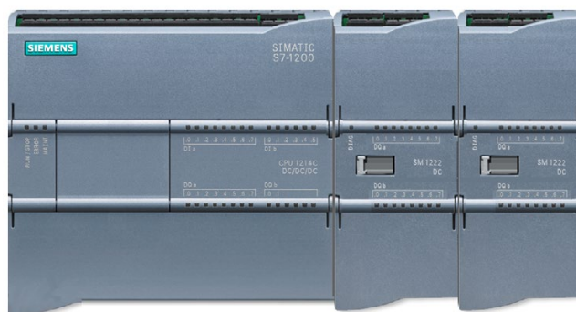
图 6-2 插槽 3 中组态的模块不存在，以及插槽 4 的组态模块位于实际插槽 3 中时的实际安装
