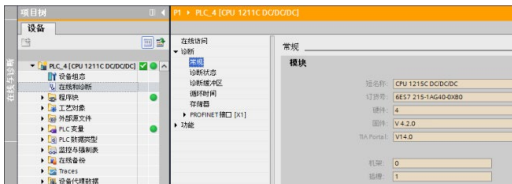
图 7-1 组态的 CPU 与连接的 CPU 不同时的在线视图
