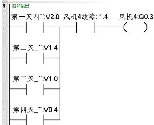
(3) 故障控制程序 (SBR3)，每台风机的故障均使用复位优先的指令作处理，故障发生时采用系统时钟 SM0.5 做指示灯的闪烁处理。
