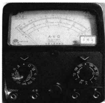
图 4-16 转换开关均旋至空挡
