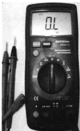
图 6-11 转换开关 转至 \Omega \rightarrow \text{二极管} 挡
