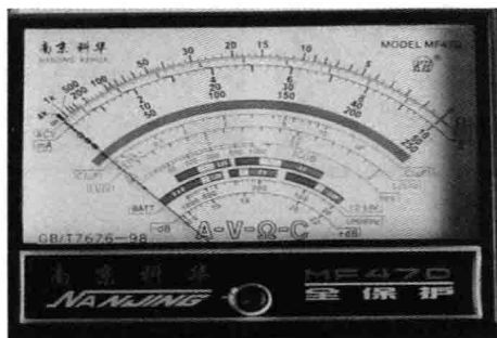
图 1-6 MF47D 型模拟式万用表的刻度盘
