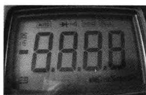
图 5-3 液晶显示器示意图
