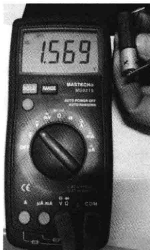
图 5-26 测量干电池电压
