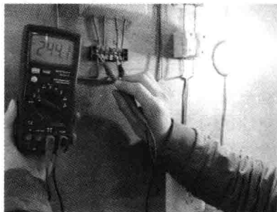
图 5-19 测量照明线路的电压
