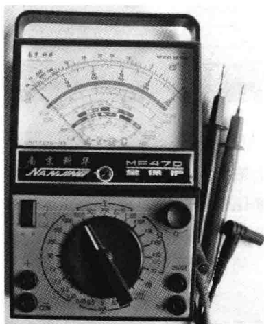
图 3-30 转换开关置于交流电压最高挡
