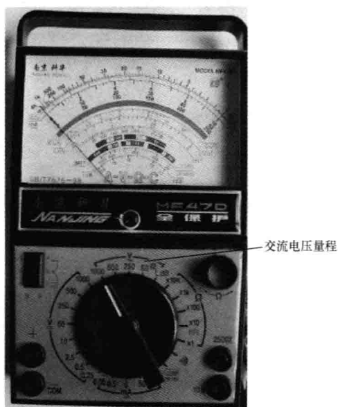
图 3-12 MF47D 型模拟式万用表交流电压量程
