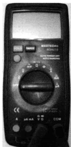
图 5-34 转换开关置于 OFF 挡
