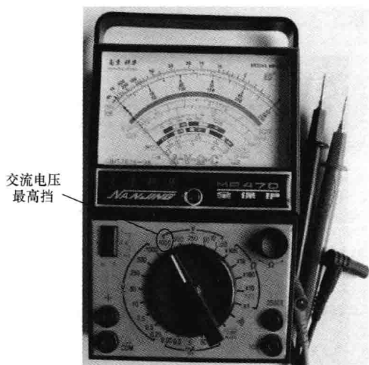
图 3-19 转换开关置于交流电压最高挡
