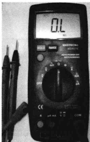
图 6-17 转换开关转至 \Omega 挡
