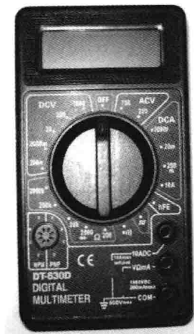
图 7-27 转换开关置于 OFF 挡
