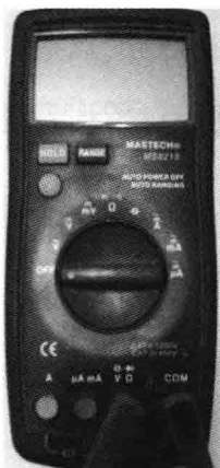
图 5-11 转换开关置于 OFF 挡
