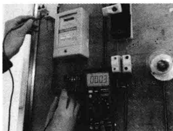
图 5-13 照明线路通断的判断
