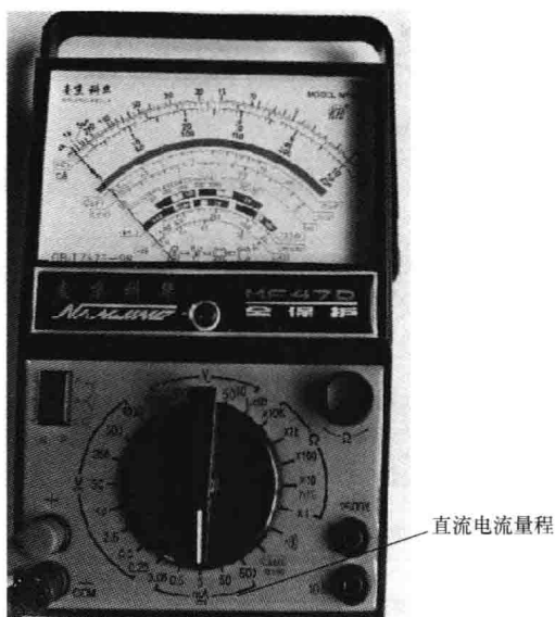
图 3-23 MF47D 型模拟式万用表直流电流量程
