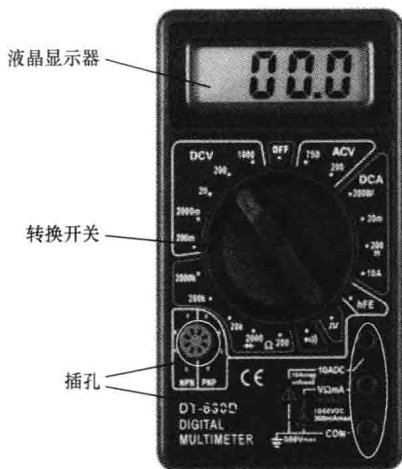
图 7-2 DT830D 型数字式万用表的面板结构
