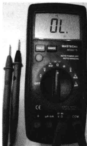
图 6-18 通断测试状态
