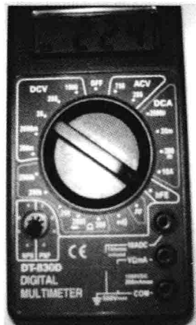
图 7-34 测量三极管的 \beta 值
