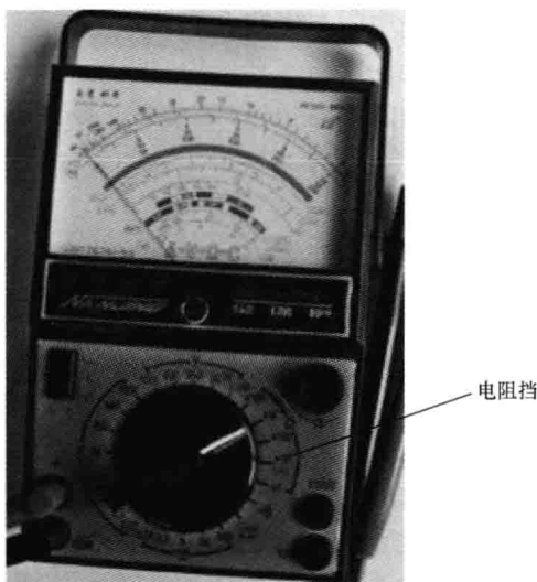
图 1-22 万用表的电阻挡
