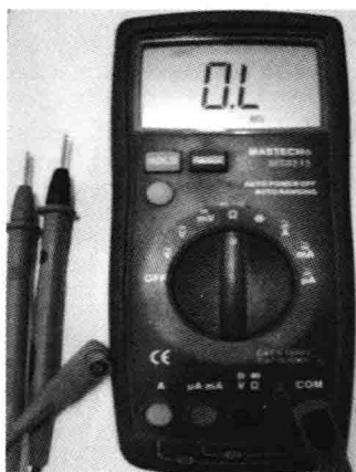
图 5-7 转换开关拨至 \Omega 挡
