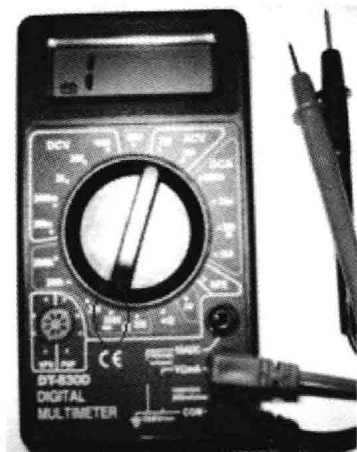
图 7-16 转换开关旋至二极管挡
