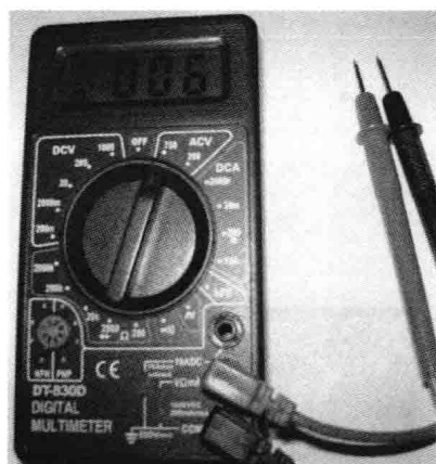
图 7-19 转换开关旋至 ACV 挡
