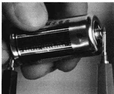
图 4-31 测量直流电压
