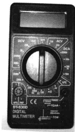
图 7-10 转换开关置于 OFF 挡
