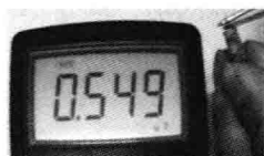
图 6-4 读取电容容量
