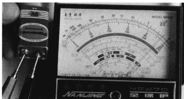
图 3-7 读电池的电压
