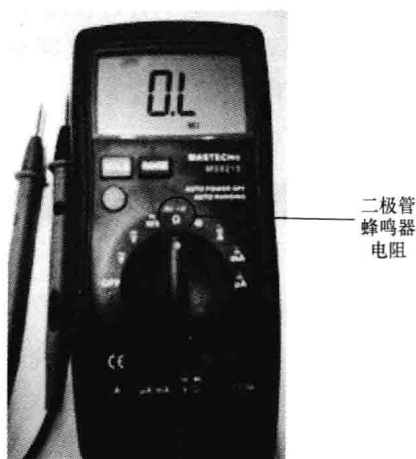
图 6-21 旋转开关转至 \Omega 挡
