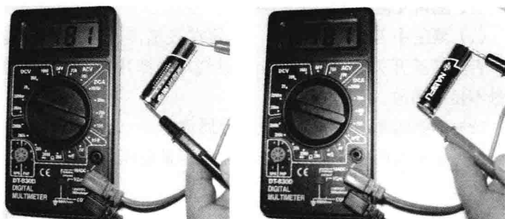
图 7-25 测量直流电压
