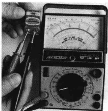
图 3-6 测量电池的电压
