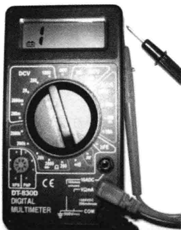
图 7-31 转换开关转至 \Omega 挡
