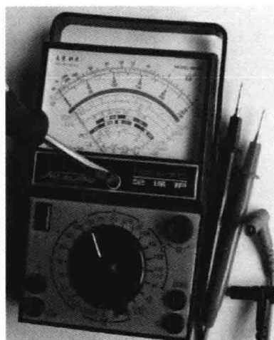
图 3-25 调节机械调零旋钮
