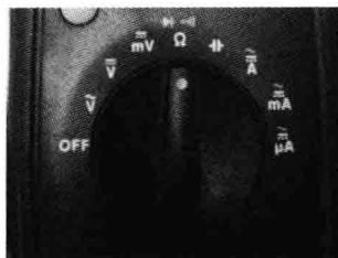
图 5-4 转换开关示意图
