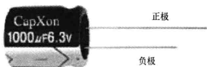
图 2-4 电解电容器的极性
