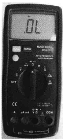
图 6-12 二极管测 试状态
