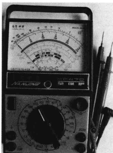
图 1-1 MF47D 型模拟式万用表
