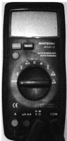
图 6-5 转换开关置于 OFF 挡
