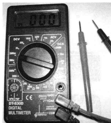
图 7-24 转换开关旋至 DCV 挡
