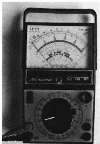
图 3-5 选择合适的量程
