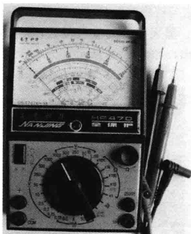
图 3-8 转换开关置于交流电压的最高挡
