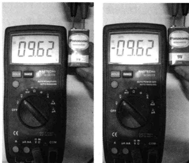
图 5-23 测量直流电压
