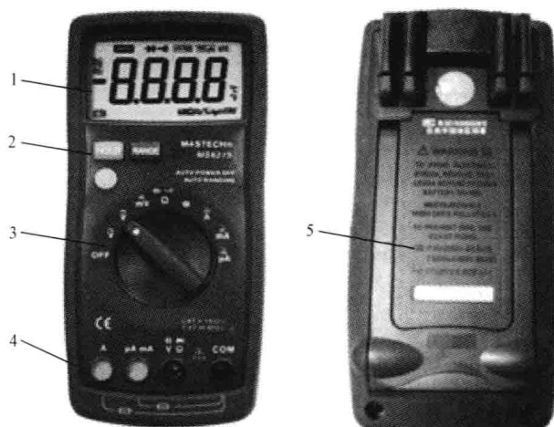
图 5-2 MS8215 型数字万用表的面板结构
