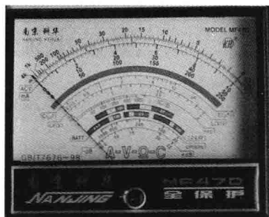
图 1-2 MF47D 型模拟式 万用表的表头
