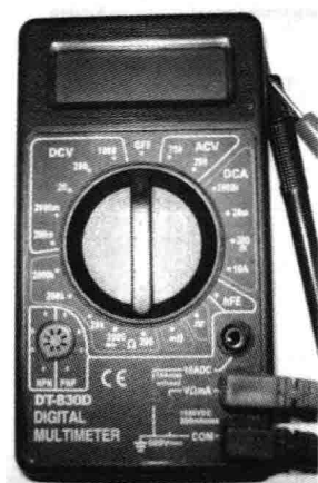
图 7-23 将表笔插入插孔
