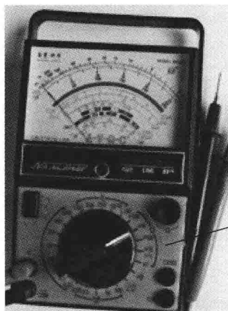
图 1-14 万用表的电阻挡
