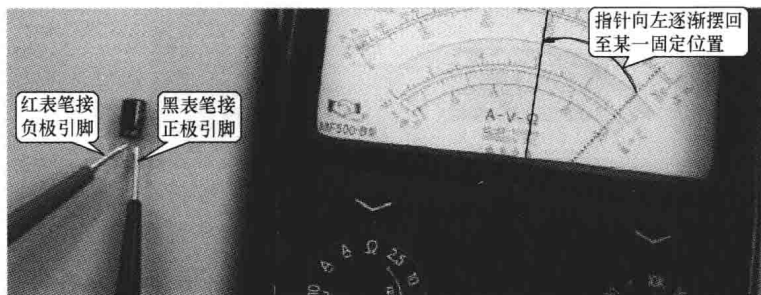
图 4-25 检测电解电容器
