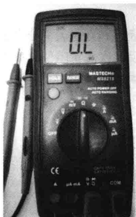
图 6-6 转换开关转至 \Omega 挡
