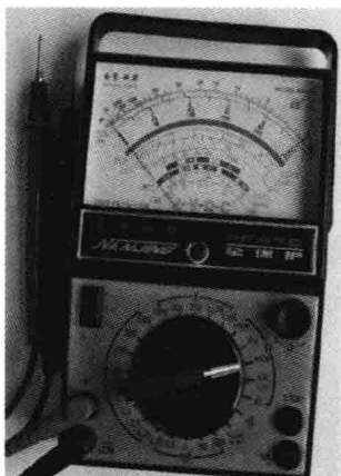
图2-1 转换开关置于适当的电阻倍率挡
