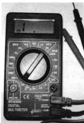
图 7-7 转换开关拨至 Ω 挡
