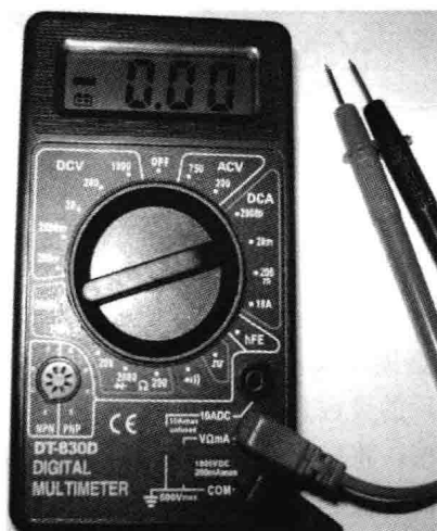
图 7-30 转换开关转至 20mA 挡
