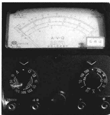
图 4-33 转换开关置于空挡
