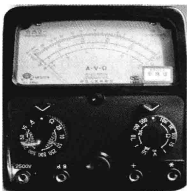
图 4-9 万用表水平放置
