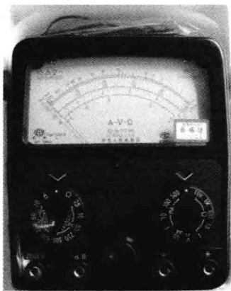
图 4-1 MF500 型模拟式万用表
