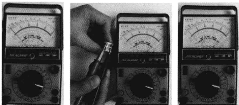
图 2-7 检测电感线圈示意图
