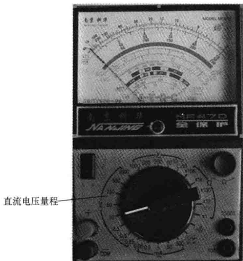
图 3-1 MF47D 型模拟式万用表直流电压量程
