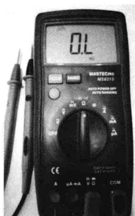
图 5-8 将表笔插入插孔
