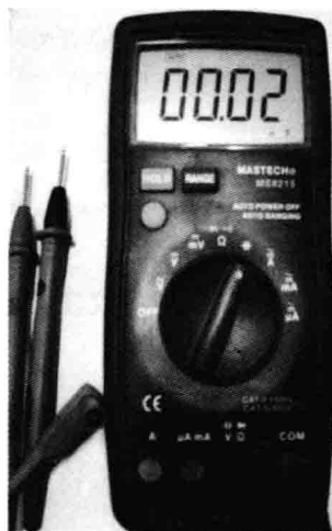
图 6-1 转换开关转至 \text{H}\Omega 挡
