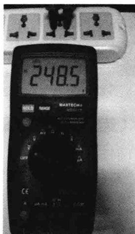
图 5-16 测量交流电压
