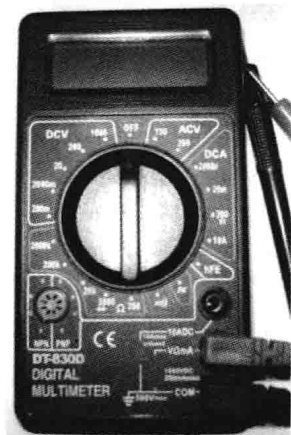
图 7-18 将表笔插入插孔
