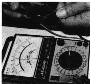
图 2-5 检测电解电容器的好坏
