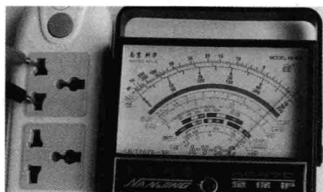
图 3-18 读市电电压值
