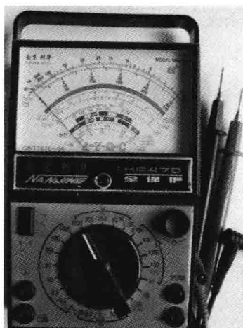
图 1-11 万用表水平放置示意图
