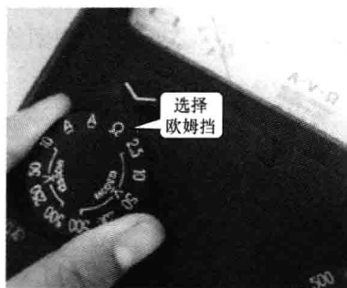
图 4-17 转换开关旋至适当挡
