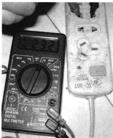
图 7-20 测量交流电压
