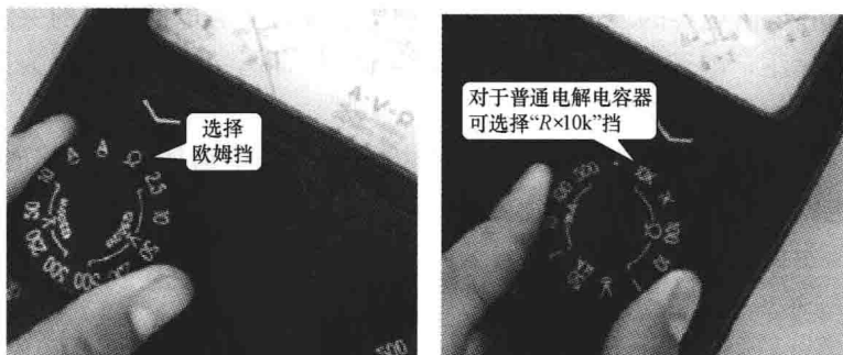
图 4-23 转换开关旋至适当挡
