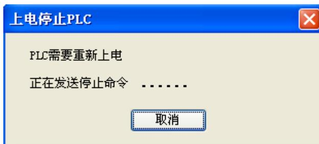
IV) 此时, 您直接将 PLC 电源断电, 断电约 2~3 秒钟再重新给 PLC 上电, 正常情况下会跳出一个上电停止 PLC 成功窗口; 如果 PLC 重新上电没有跳出成功停止窗口, 可以重新再尝试几次, 直至跳出成功停止窗口:
