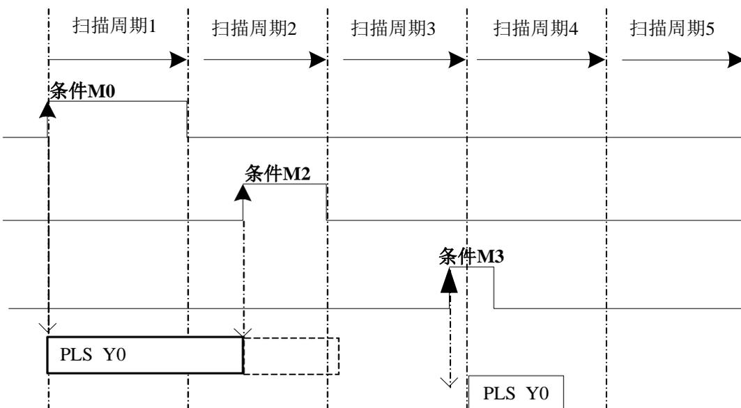
M0 由 OFF→ON 时，执行 BLOCK 里的 PLSR HD0 HD100 K1 Y0 指令，开始脉冲的发送；当 M2 由 OFF→ON 时，BLOCK 暂停执行，此时立即停止脉冲发送；当 M3 由 OFF→ON 时，开始发送之前未发完的脉冲个数。
