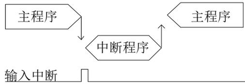
注意:原 XC 系列 PLC 中外部中断不能够实现上升沿和下降沿共同触发的问题在 XD/XL 系列 PLC 中可以得到彻底解决,外部中断可同时支持上升沿和下降沿。
