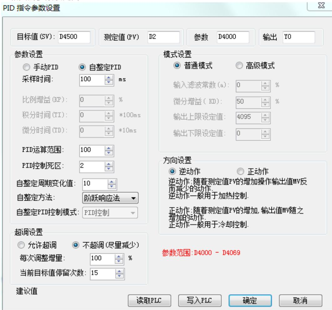
图 3 PID 自整定不允许超调参数设定
