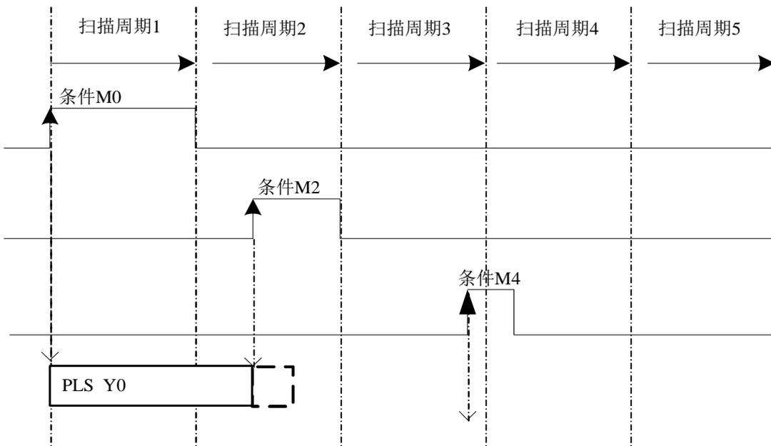
M0 由 OFF→ON 时，执行 BLOCK 里的 PLSR HD0 HD100 K1 Y0 指令，开始脉冲的发送；当 M2 由 OFF→ON 时，BLOCK 暂停执行，此时立即停止脉冲发送；当 M4 由 OFF→ON 时，舍弃之前未发完的脉冲。
