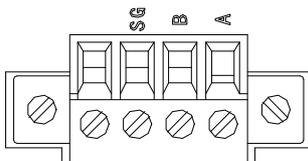
在使用 RS485 方式通讯的时候, 请使用双绞线 (如下图), 如果条件允许, 可使用屏蔽双绞线, 并且单端接地, 如无可靠地也可悬空。
