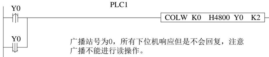
当 Y0 状态发生改变的时候，将上位机的 Y0 状态广播到所有下位机，广播时候三台下位机 PLC 的同步性较第一种方法更好。
