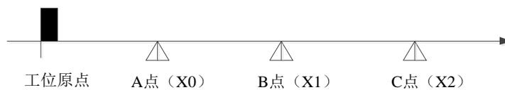
如上图所示，现需要正向走 3 段工位，由于 A、B、C 三点的位置是不确定（会随机变动），且要求从工位原点到 A 点、A 点到 B 点、B 点到 C 点三段的移动速度都不一样但都是固定的，在这种情况下我们可以通过结合 PLSF 指令以及外部中断的功能来实现；我们可以分别在 A、B、C 三点的位置安装一个接近开关，接入 PLC 的 X0、X1、X2 三个端子（假如 X0、X1、X2 三个端子全部为外部中断端子，上升沿中断编号分别为 I0000、I0100、I0200，具体型号 PLC 的外部中断端子请参见“外部中断端口定义”）；脉冲端子为 Y0，方向端子由 Y2 来控制，为了提高速度变换的精度，加减速时间设定为 0，通过外部中断进行速度快速切换，每段的脉冲频率与对应的寄存器如下表所示：
