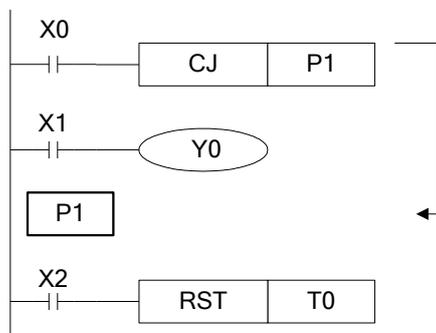
当线圈 X0 接通时，跳转到 P1 标记的后一步，不执行中间部分程序。
