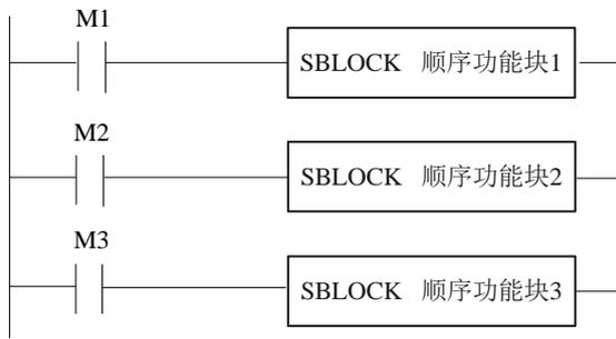
如图所示，顺序功能块 1，顺序功能块 2，顺序功能块 3 是同步执行的。当 M1，M2，M3 为 ON 的时候，所有 Block 循环执行。
