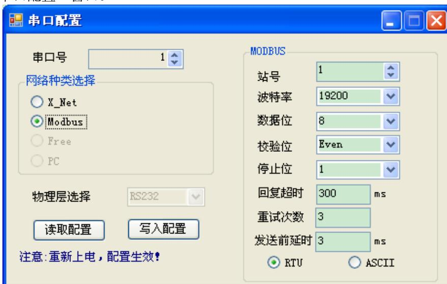
串口号：K0~K5。K0：COM0 (RS232)；K1：COM1 (RS232)；K2：COM2 (RS485) 或 COM2-RS232
