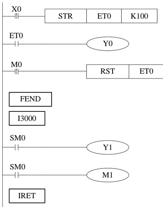
当 X0 从 OFF→ON 时，定时器 ET0 开始计时，时间累计到 100ms 时，ET0 置位；同时产生一个中断，程序跳转到中断标记 I3000 处执行一次中断子程序。
