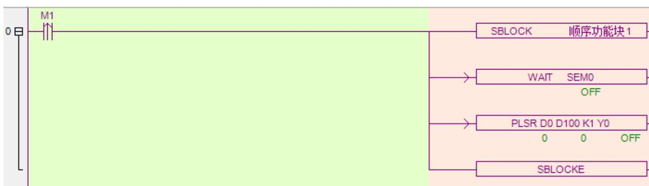
**注意：**在 XD/XL 系列 PLC 的顺序功能块的 WAIT 指令后面不能够添加普通的内部线圈，只能添加信号量 SEM 位（SEM0~SEM31 共 32 个）；信号量 SEM 位的状态不能够通过 SET 与 RST 来进行控制，只能通过 POST 指令对它进行置位，而当执行完 WAIT SEM 指令后会自动对 SEM 位进行复位；或者通过 OUT 指令输出。两者的区别在于，用 POST 指令需要用边沿触发，可保持住 SEM 的状态；用 OUT 需要用常开触发，断开导通条件 SEM 就复位。
