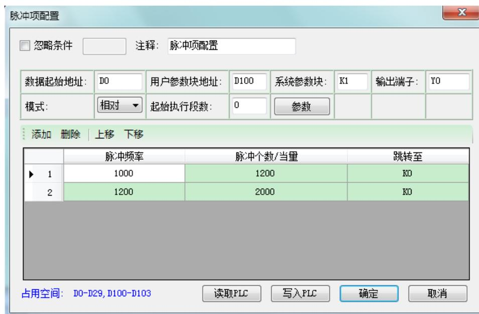
在该配置面板中可设定脉冲输出的形式，相对或者绝对；其他参数相应的输入区中写入参数的地址，以及脉冲频率以及脉冲个数、跳转条件等。
