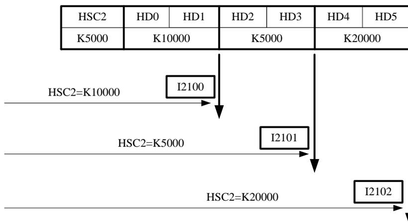
**注意：**非凸轮模式下的绝对计数时，计数中断是按顺序依次产生的，即先产生第 1 段中断，再产生第 2 段中断，再产生第 3 段中断……当某段中断产生之后，即使计数值再次达到该段中断的设定值，也不会产生中断。
