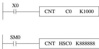
本指令所能计数的最高频率和滤波参数的选择以及 PLC 扫描周期相关；输入频率超过 25Hz 建议用高速计数器。高数计数器必须使用 HSC0-HSC30 以及对应的硬件接线。
