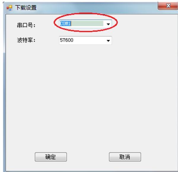
**注意：**只需要根据您的电脑实际串口号设定通讯端口即可，波特率无需修改。
