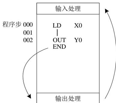
可编程控制器反复进行输入处理、程序执行和输出处理。若在程序的最后写入 END 指令，则 END 以后的其余程序步不再执行，而直接进行输出处理。在程序中没有 END 指令时，XC 可编程控制器一直处理到最终的程序步，然后从 0 步开始重复处理。
