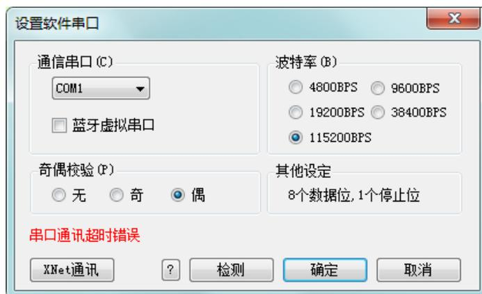
此时您可以根据 PC 机的连接串口，选择正确的通讯串口号；波特率选择 19200BPS，奇偶校验选择偶校验，8 个数据位，1 个停止位；您也可以通过直接点击窗口里面的“检测”按钮，由 PLC 自行选择通讯参数，成功连接后的窗口左下角将会显示“成功连接 PLC”，显示如下：
