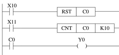
C0 对 X11 的 OFF→ON 次数进行增计数，当 C0 达到设定值 K10 时，输出触点 C0 动作，即 C0 的状态由 OFF 转变为 ON。此后，当 X11 继续由 OFF→ON 变化时，计数器的当前值会继续自加，输出触点仍保持动作。当 X10 接通时，计数器的当前值清零，输出触点复位。
