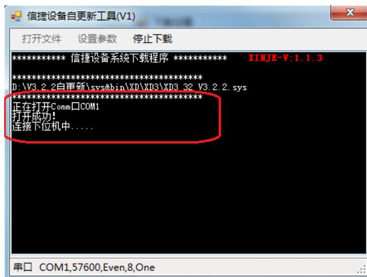
(7) 将 PLC 断电再重新上电，PLC 就开始自更新了，更新可能需要几分钟的时间，当数据停止更新出现“传送完毕”时说明已经更新好。
