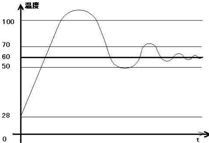
图 2 PID 自整定允许超调波形图
