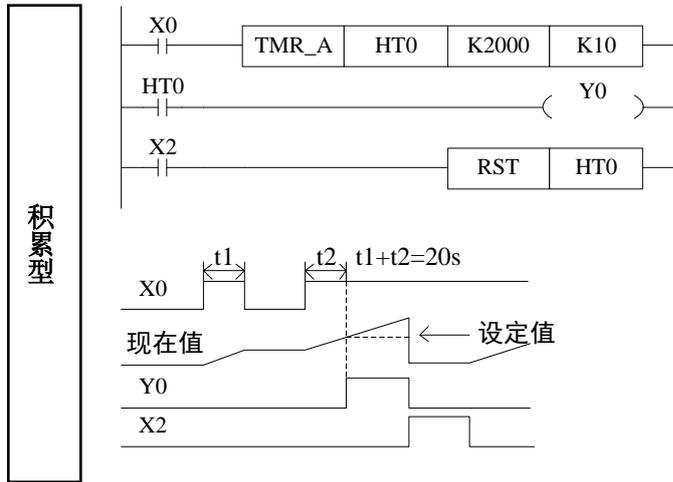
如果定时器线圈 HT0 的驱动输入 X0 为 ON, 则 HT0 用当前值计数将累计 10ms 的时钟脉冲。当该值达到设定值 K2000 时, 定时器的输出触点动作。在计算过程中, 即使输入 X0 断开或停电时, 再重新启动 X0 时, 继续计算, 其累计计算动作时间为 20 秒。如果复位输入 X2 为 ON 时, 定时器复位, 输出触点也复位。
