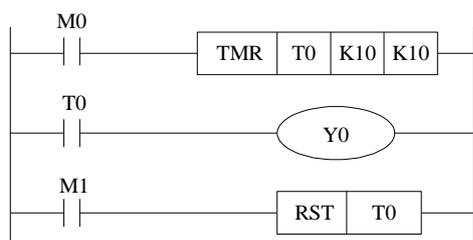
对线圈 M0 的 OFF→ON 的通断进行计时，当 T0 达到设定值 K10 时，输出触点 T0 动作，即 T0 的状态由 OFF 转变为 ON。此后，定时器 T0 的值仍然继续计时；为了将此清除，令 M1 为接通状态，使输出触点复位。
