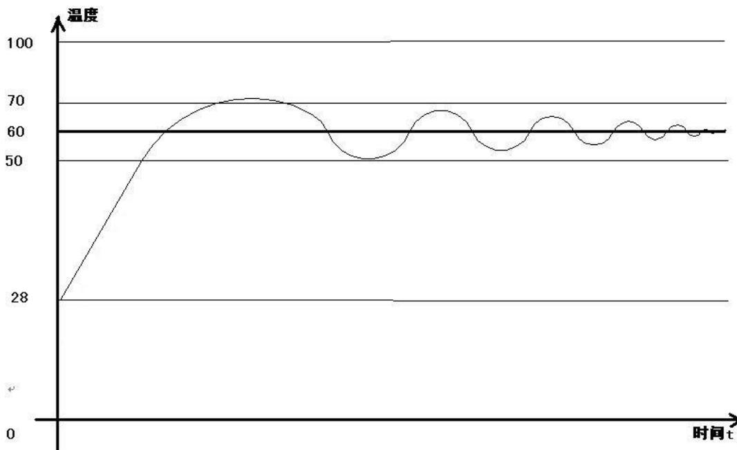
图 4 PID 自整定允许超调波形图
