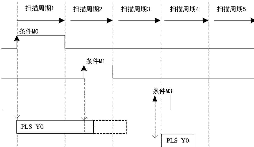
M0 由 OFF→ON 时，执行 BLOCK 里的 PLSR HD0 HD100 K1 Y0 指令，开始脉冲的发送；当 M1 由 OFF→ON 时，BLOCK 暂停执行，此时脉冲走斜坡，缓慢停止；当 M3 由 OFF→ON 时，发送之前未发完的脉冲个数。
