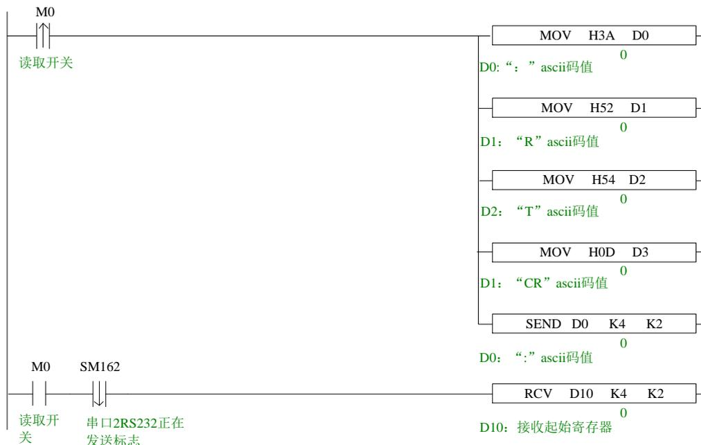
在尝试 PLC 与其他智能设备通讯时，建议先使用串口调试工具（可选用信捷的 T-COM）将通讯的数据格式即协议确定好，这样做的好处是：串口调试工具修改方便、使用灵活；在串口调试工具确定可以通讯成功之后，按照得到的数据格式编写 PLC 程序，这样往往事半功倍。
