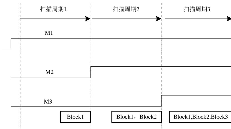
**注意：**当 BLOCK 块中的程序未执行完，而导通条件 M 断开了，BLOCK 并不会立即停止而是完成最后一次扫描，将剩下的程序执行完毕后会才会停止。
