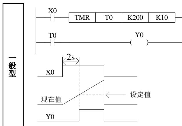
如果定时器线圈 T0 的驱动输入 X0 为 ON，T0 用当前值计数器累计 10ms 的时钟脉冲。当该值等于设定值 K200 时，定时器的输出触点动作。也就是说输出触点在线圈驱动 2 秒后动作。驱动输入 X0 断开或停电，定时器复位，输出触点复位。
