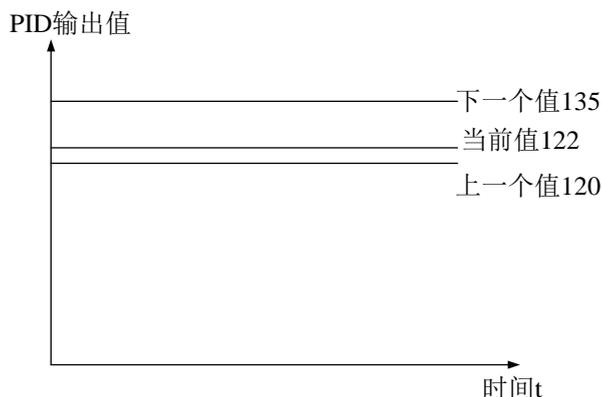
假设，此时我们设定控制死区值为 10，那么在上图中，PID 输出当前值（122）对上一个值（120）来说，变化量仅为 2，PID 运算后将结果（122）保持在内部寄存器，最终输出值保持上一次的输出值（仍为 120），下一个值 135 对 122 具有变化量 13，大于控制死区值，PID 实际输出值变为 135。
