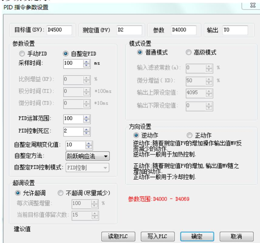
图 1 PID 自整定允许超调参数设定
