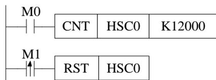
如上图，当 M0 置 ON，HSC0 开始对 X0 端口的脉冲输入进行计数；当 M1 由 OFF 变为 ON 时，对 HSC0 进行复位，同时 HSCD0（双字）中的计数值被清零。
