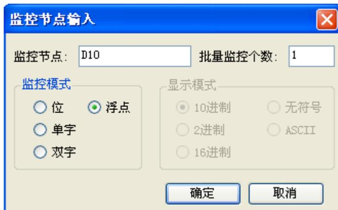
(2) 在“监控节点”框中输入 D10,“监控模式”选择浮点,点击“确认”键即可,您将会在自由监控栏中监控寄存器 D10 里面的浮点数数值。
