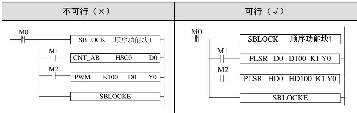
6、不建议将顺序功能块 BLOCK 放在流程 (STL) 里面使用，因为当流程执行结束跳转到下一个流程时，如果此时 BLOCK 还没有执行完或者流程结束时而 BLOCK 的触发条件还没有断开，此时可能会出现一些意想不到的问题；所以建议用户尽量将顺序功能块 BLOCK 与流程 STL 分开控制。
