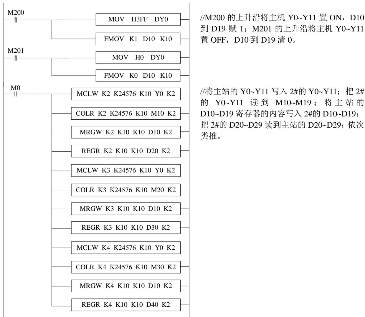
//M200 的上升沿将主机 Y0~Y11 置 ON，D10 到 D19 赋 1；M201 的上升沿将主机 Y0~Y11 置 OFF，D10 到 D19 清 0。
