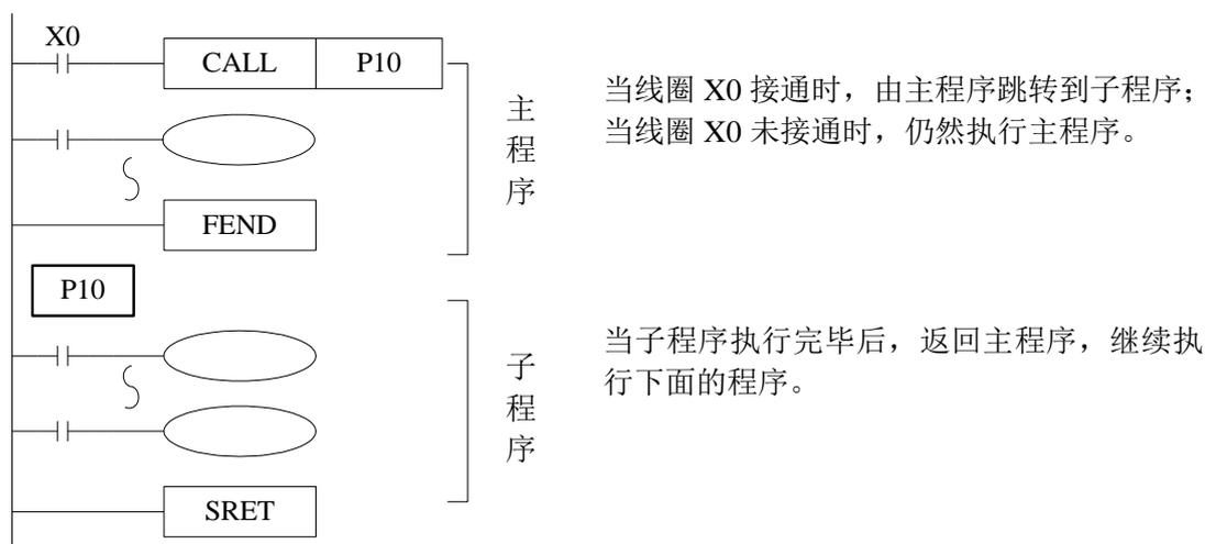
子程序调用，写程序时必须以 Pn 作为一段子程序的开始，以 SRET 作为一段子程序的结束。用 CALL Pn 调用子程序。其中 n 可以为 0~9999 中的任意整数。
