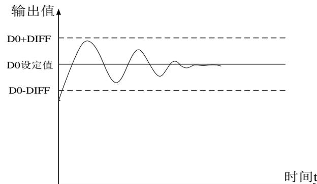
进入自整定模式,请设置  $S3+2$  的 bit7 为 1,并开通 PID 运行条件。在观察到  $S3+2$  的 bit8 为 1 (自整定成功)后,表示自整定成功。详见后面的程序案例。
