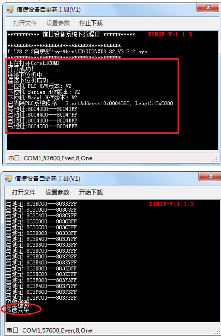
(8) 更新完毕后将 PLC 重新断电，安装好 PLC 上盖重新给 PLC 上电即可！
