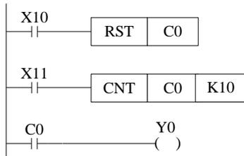
如果切断可编程控制器的电源，则一般用计数器的计数值被清除，而停电保持用的计数器则可储存停电前的计数值，因此计数器可按上一次数值累计计数。
