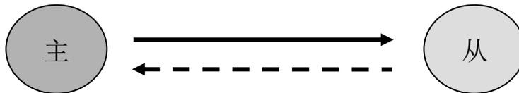
之所以图中有虚线箭头（包括 RS485 网络中），是因为理论上在两个网络中，只要各个 PLC 不发数据，网络中任意 PLC 都可以用来作为主站，其它 PLC 作为从站；但是由于多个 PLC 之间没有一个统一的时钟基准，容易出现在同一时刻有多个 PLC 发送数据，会导致通讯冲突失败，因此不建议这样使用。
