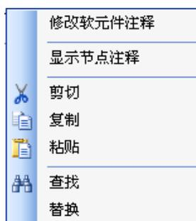
点击“修改软元件注释”, 将会跳出“编辑软元件注释”编辑窗口, 输入注释内容即可:
