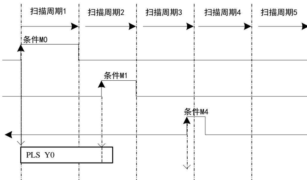
M0 由 OFF→ON 时，执行 BLOCK 里的 PLSR HD0 HD100 K1 Y0 指令，开始脉冲的发送；当 M1 由 OFF→ON 时，BLOCK 暂停执行，此时脉冲将走斜坡，慢慢停止；当 M4 由 OFF→ON 时，舍弃之前未发完的脉冲个数。
