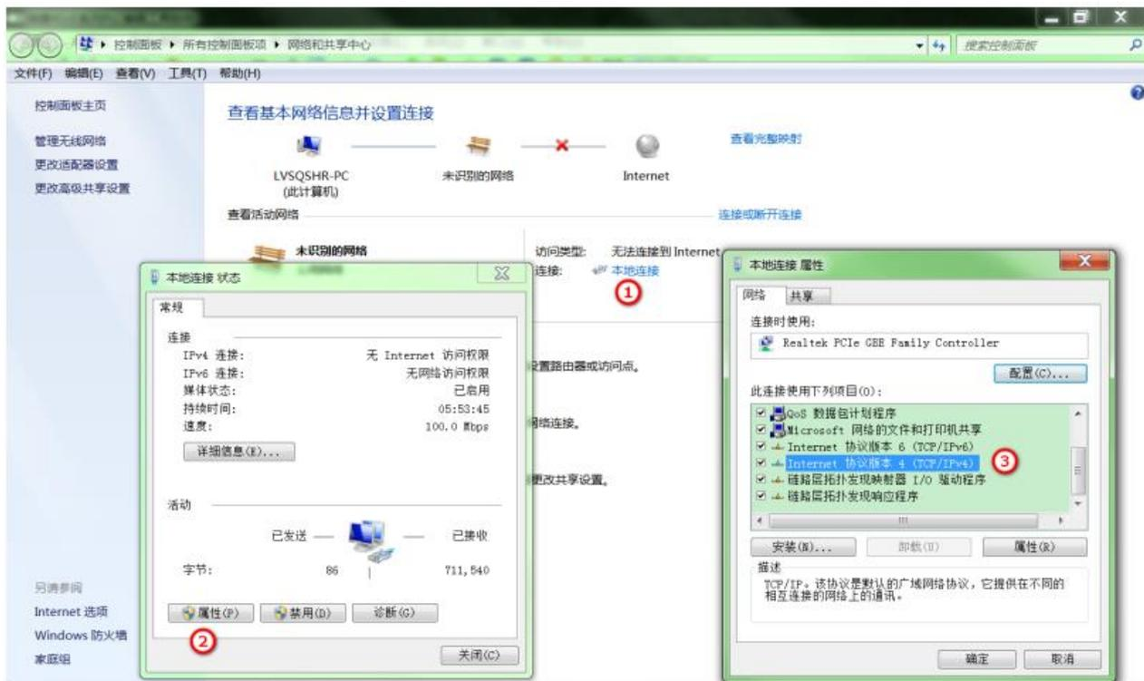
3) 按下图在 IP 地址配置界面填入对应参数，点击“确认”按钮，完成配置。注意：IP 地址必须为 6 网段，如 192.168.6.20。
