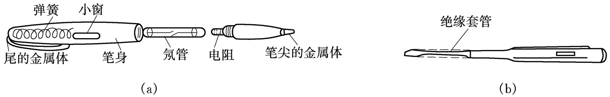
图 2.1.9 试电笔的外形结构
