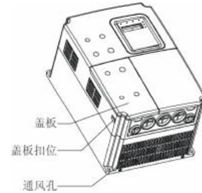
图 1-3 15kW 及以下变频器各部件名称
