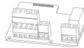
图 10-5 I/O 扩展卡外形示意图
