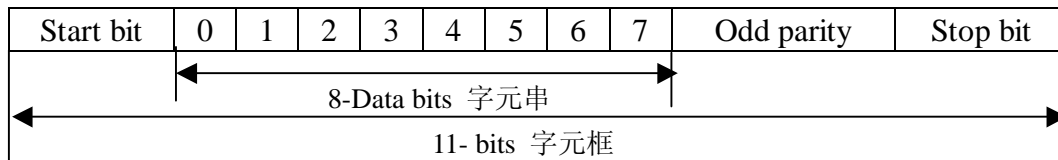
(6)8O1 For RTU C111=5
