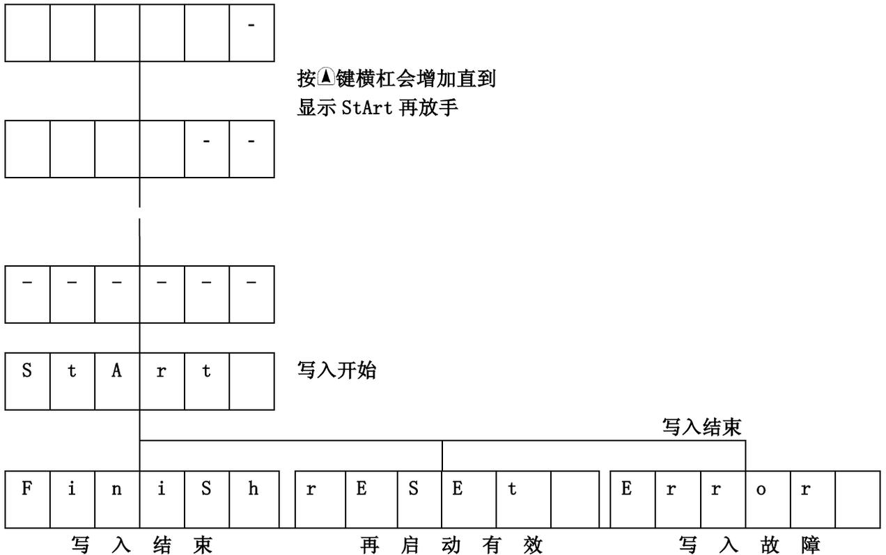
■ 如果写入后显示 rEsEt，表示写入参数值必须在系统复位后再有效，请断电再重新启动。
