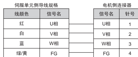
(2) 不带保持制动器的伺服电机接线规格: 750W, 1.5kW
