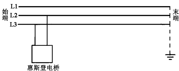
图 5-2-4 线路直流电阻测量接线图
