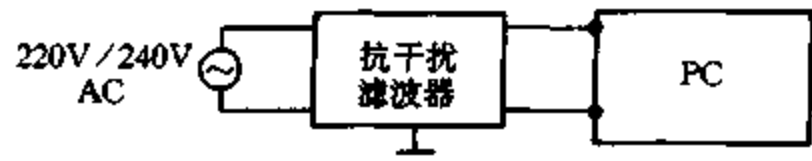
图 4.8.4 加抗干扰滤波器
