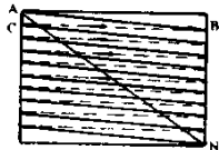
图 2-2-2 电子束扫描示意图
