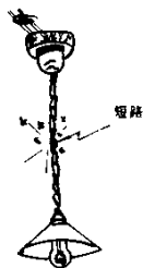
图 1-1-15 导线绝缘损坏引起短路
