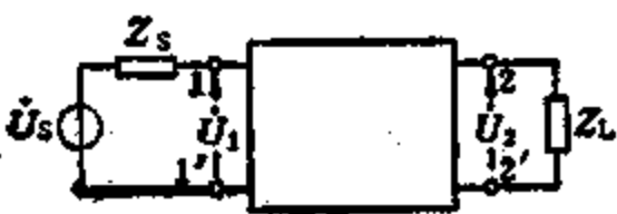
图5.1-3 滤波器的两端终接阻抗
