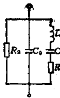
图5-1-12 陶瓷振子等效电路
