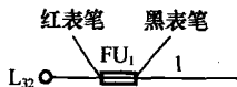
图 4-2-95 电阻测量法排除正、反转接触器互锁控制回路断路故障步骤 4
