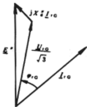
图 14 同步发电机在额定工况下的相量图
