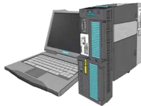
可选 PC 连接套件 2 亦可用于设置参数，操作和监测变频器；此套件用于建立 PC 和控制单元之间的通讯。
