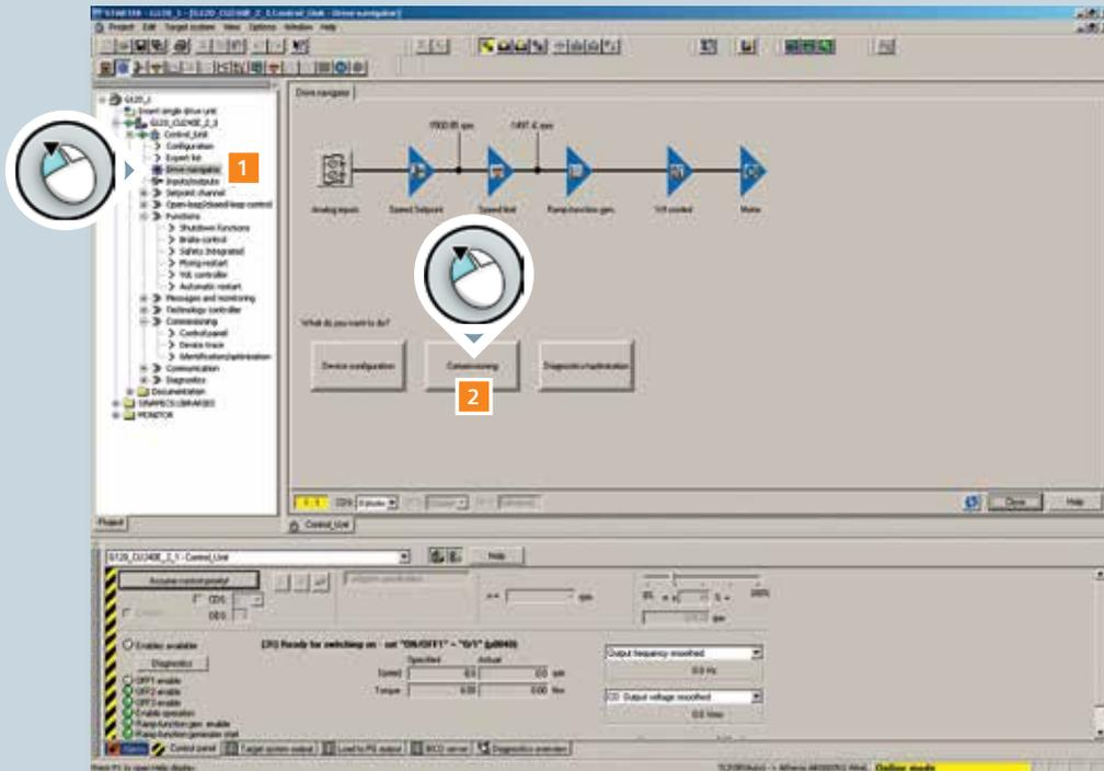
3 选择“Save data in drive (RAM to ROM)”，将参数设置存储到变频器的 EEPROM 存储器
