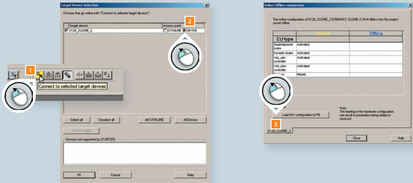
现在变频器数据已加载到项目内，且 PC 和变频器之间已建立在线连接。
