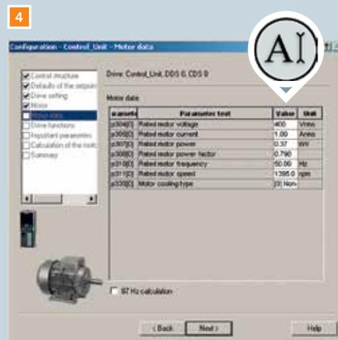
对于非西门子电机，请使用电机铭牌输入电机数据。
