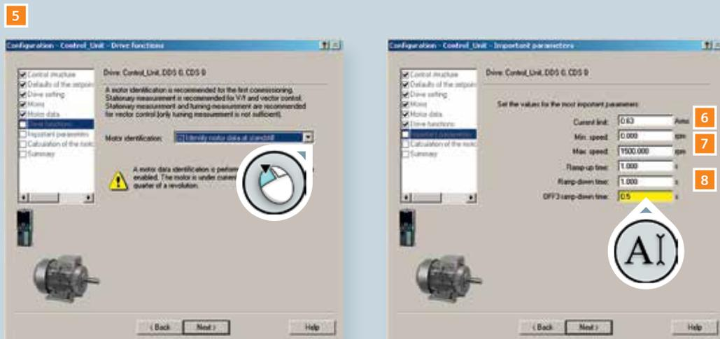
点击“Next”，将开始计算电机数据。这样便通过配置向导完成了参数设置。您现在将收到一份有关输入的所有参数值汇总。按“Copy text to clipboard”按钮即可将汇总添加到文本文件。最后选择“Copy RAM to ROM”，将参数设置保存到变频器 ROM 存储器内，然后点击“Finish”关闭窗口。
