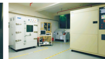
自然对流测试箱（左）， 冷热冲击测试箱（右）
