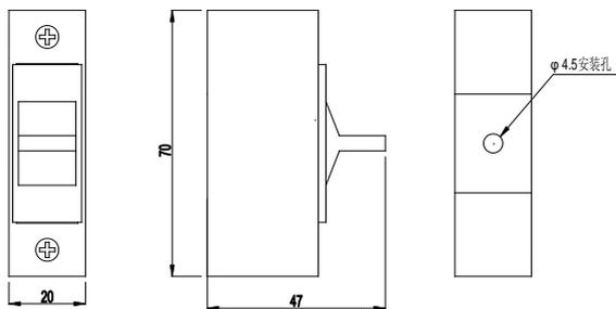
图 B.11 熔断器底座尺寸图 (单位 mm)
