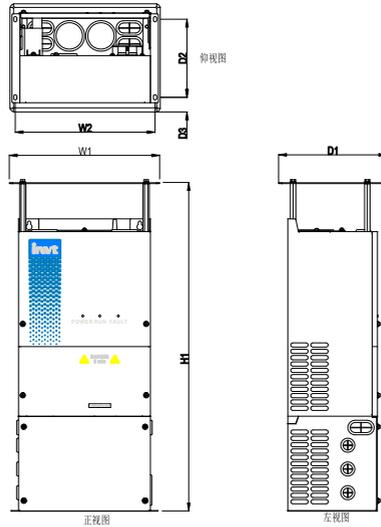
图 A.3 AC220V 系列 7.5~45kW/AC380V 系列 15~90kW 落地安装（带顶盖）示意图
