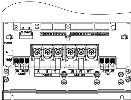
图 2.2 AC380V 系列 15~22kW 主回路端子示意图
