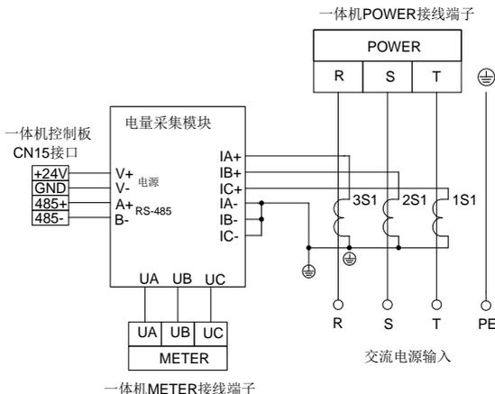
图 B.1 电量检测组件电气接线图
