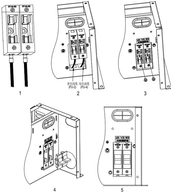
图 B.8 熔断器底座安装示意图
