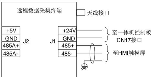
图 B.13 远程数据采集终端电气接线图
