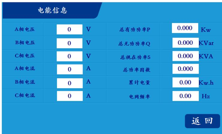
图 B.6 电量检测信息显示界面
