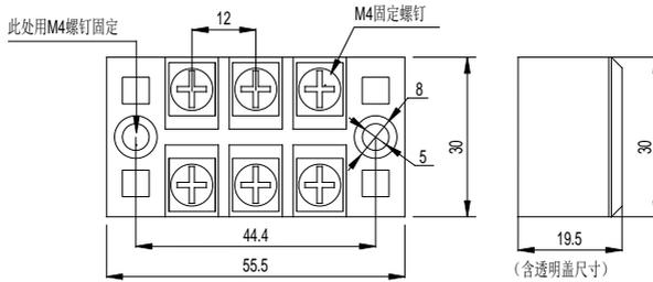
图 B.10 转接端子尺寸图 (单位 mm)
