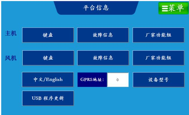
点击“风机”右侧的“键盘”选项，进入风机虚拟键盘界面，在“功能码地址”栏输入 P07.27~P07.32，可查询具体的故障代码，如下图所示：
