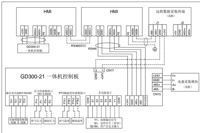
图 2.7 控制回路接线示意图
