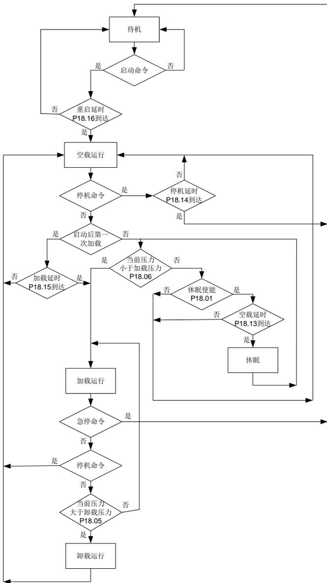
(2) 空压机运行过程压力和运行频率控制如图所示:
