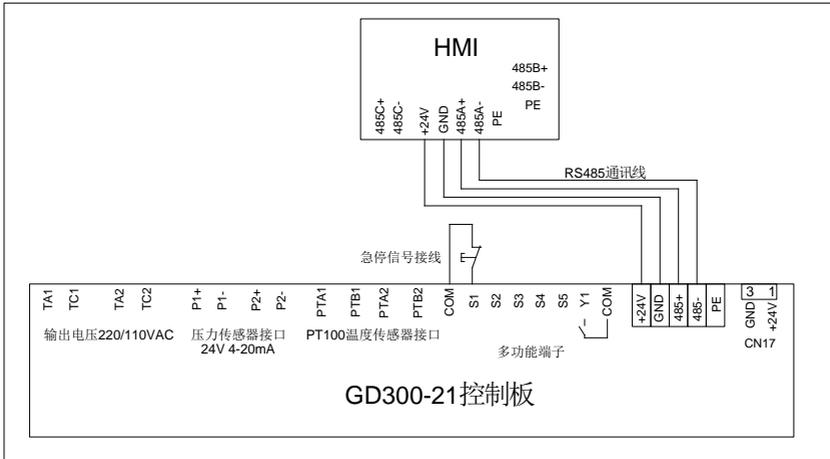
图 B.21 触摸屏标配线缆连接线
