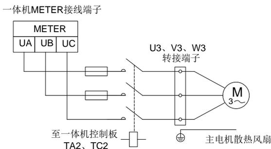
图 B.7 接触器组件电气接线图
