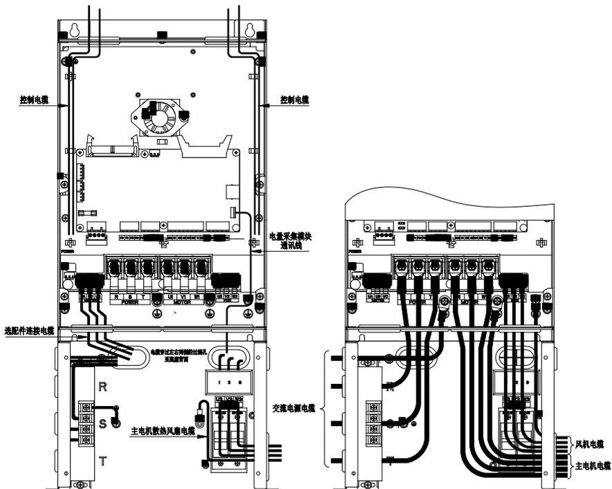
图 B.20 控制回路和主回路接线示意图
