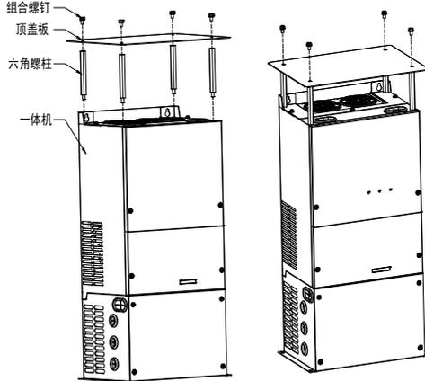
图 B.16 防滴水顶盖安装示意图
