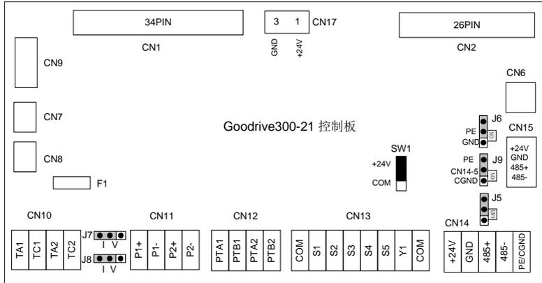
图 2.4 控制回路布局示意图
