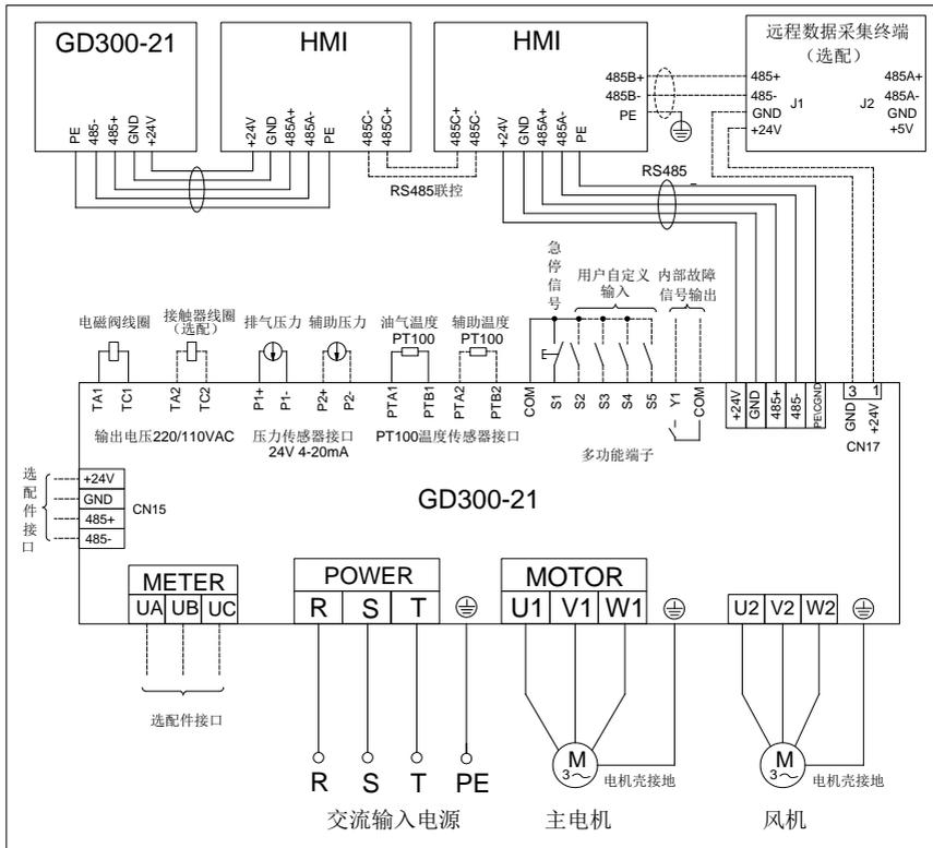
图 4.1 空压机一体机系统接线图
