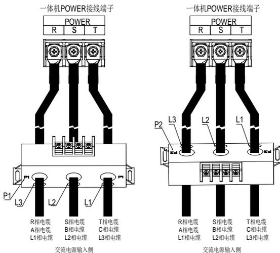
图 B.2 电流互感器接线示意图
