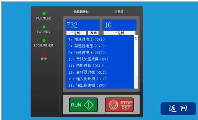
根据虚拟键盘上显示的故障代码，请按照表 6.1 Goodrive300-21 空压机一体机故障内容及对策对应的故障对策进行处理。
