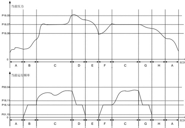
图中，P18.05 为卸载压力，P18.06 为加载压力，P18.07 为设定压力。
