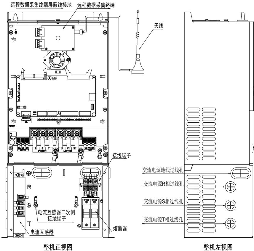
图 B.19 底座选配件安装示意图
