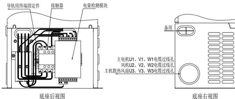
图 B.18 底座选配件背面接线示意图
