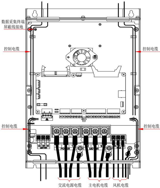
图 4.3 AC380V 系列 15~22kW 正面接线示意图
