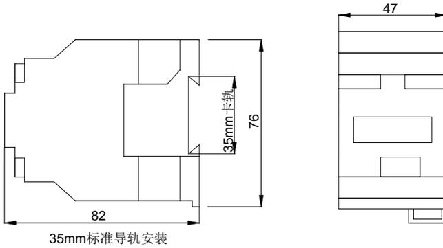
图 B.9 接触器尺寸图 (单位 mm)
