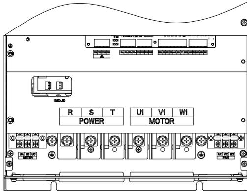
图 2.3 AC380V 系列 45~90kW 主回路端子示意图
