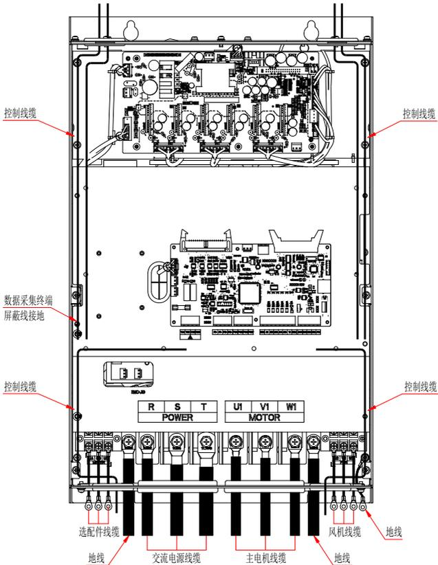
图 4.5 AC380V 系列 45~ 90kW 正面接线示意图
