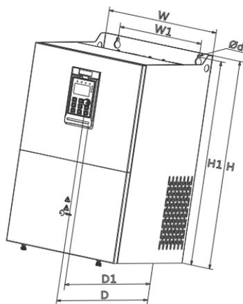
图 2-1-2 11kW-110kW 外形尺寸示意图
