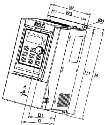
图 2-1-1 0.75kW-7.5kW 外形尺寸示意图
