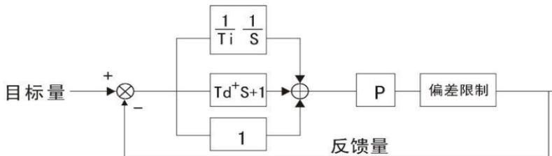
图 6-21 过程 PID 原理框图
