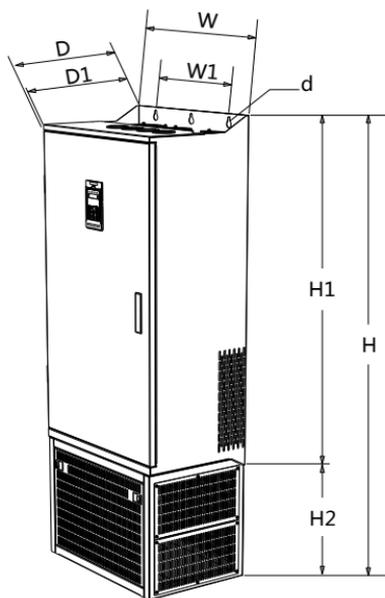
图 2-1-3 132kW-400kW 外形尺寸示意图
