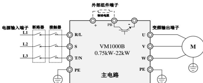
图 2-3-1 0.75kW-22kW 主端子示意图
