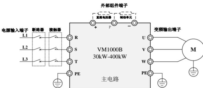
图 2-3-2 30kW-400kW 主端子示意图
