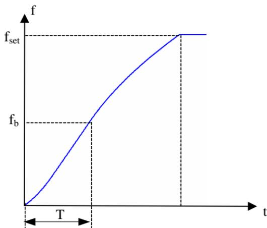
图 6-3 S 曲线加减速 B 示意图
