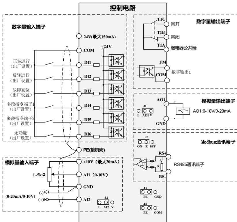
图 2-4-1 0.75kW-7.5kW 控制回路接线图
