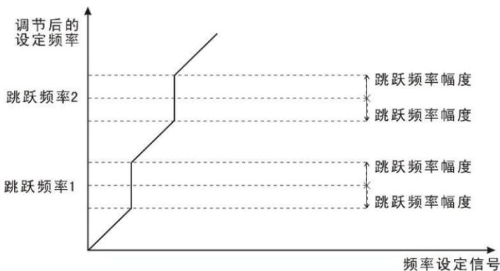
图 6-14 加减速过程中跳跃频率有效示意图
