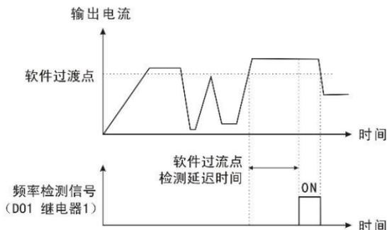
图 6-19 软件过流点检测示意图
