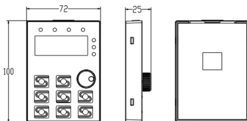
图 2-2-2 11kW—400kW 键盘尺寸图
