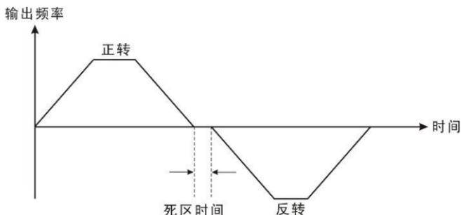
图 6-11 正反转死区时间示意图
