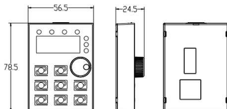
图 2-2-1 0.75kW—7.5kW 键盘尺寸图
