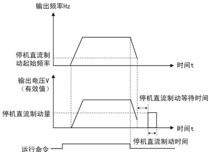
图 6-4 停机直流制动示意图
