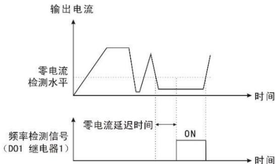
图 6-18 零电流检测示意图
