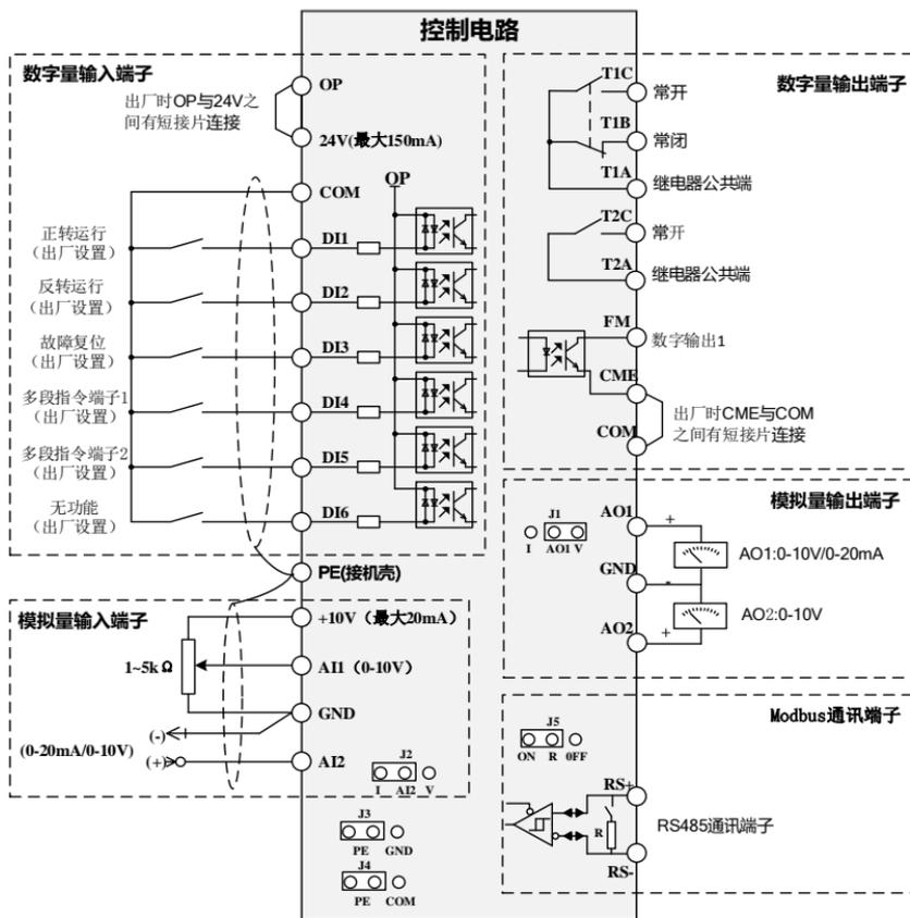
图 2-4-2 11kW-400kW 控制回路接线图
