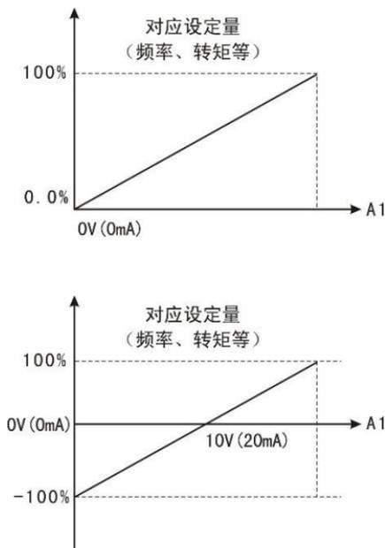
图 6-9 模拟给定与设定量的对应关系
