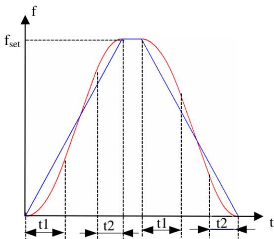
图 6-2 S 曲线加减速 A 示意图
