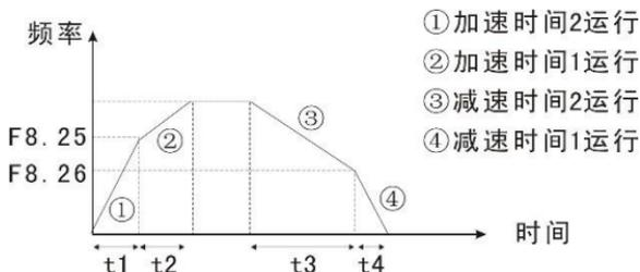
图 6-15 加减速时间切换示意图
