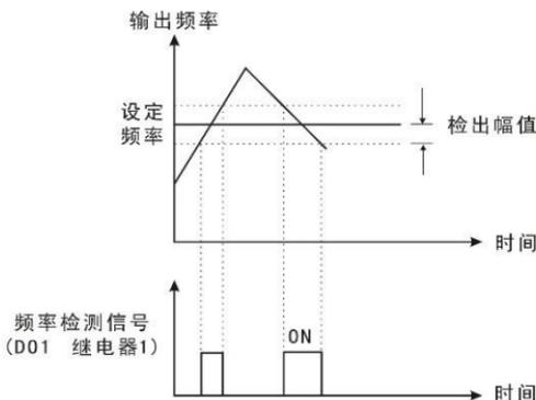
图 6-13 频率到达检出幅值示意图
