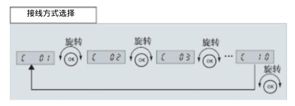
? 在"接线方式选择"模式下进行接线方式代码设置(举例)
