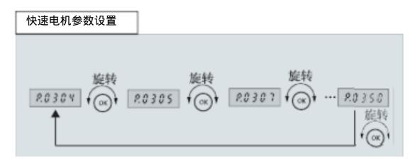
? 在"快速电机参数设置"模式下进行参数设置(举例)
