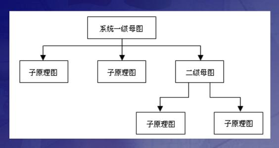
每个层次原理图设计的项目中有一个母图,母图对应着整个项目。整个项目被分成若干个模块,各个模块分别被绘制在层次原理图的子图中,子图中有输入输出端口以便整个电路的其它部分连接。子图在母图中用方块电路图表示,方块电路端口之间用导线或总线连接起来,以形成一个完整的电路。
