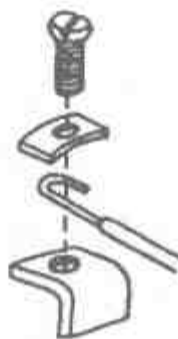
图 2-10 导线与瓦板形接线桩的连接
