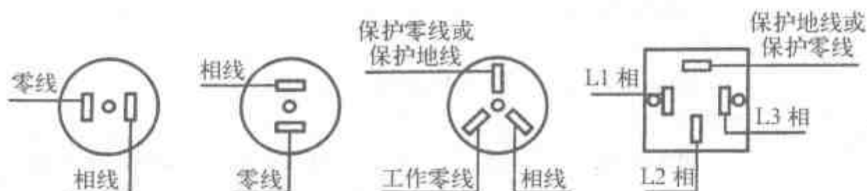
图 4-3 插座的接线方式
