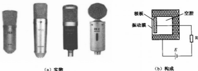
图 4-89 普通电容式话筒实物和构成
