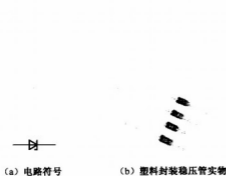
图 4-24 稳压管电路符号和实物
