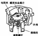
图 2-61 碟形过载保护器的构成
