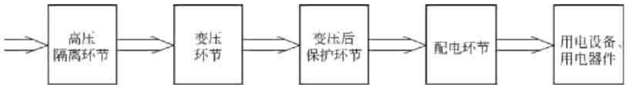
图 3-9 小型变配电电路组成框图
