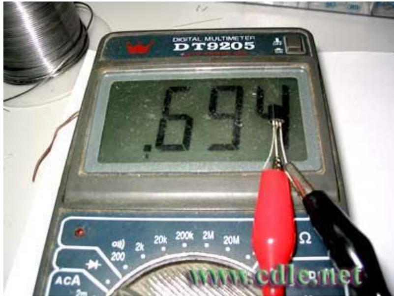
图 4 判断 bc337的 b极和管型 (2)
