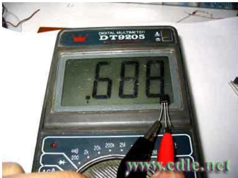
图 4 判断 bc337的 b极和管型 (1)
