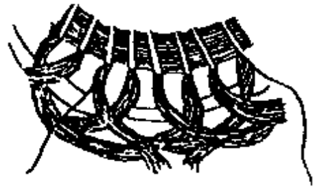
图 3-251 将线圈导线断头撮起来
