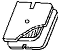
图 4-127 绕制定子绕组的木模
