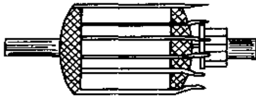
图 4-140 用白纱带将绕组一端绑住
