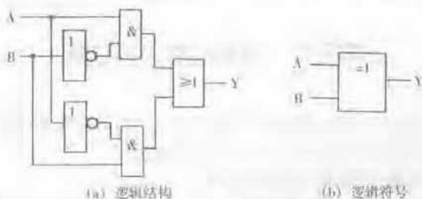
图 4-25 异或门的逻辑结构和逻辑符号
