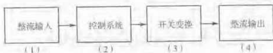
图 5-51 开关稳压器的基本结构方框图
