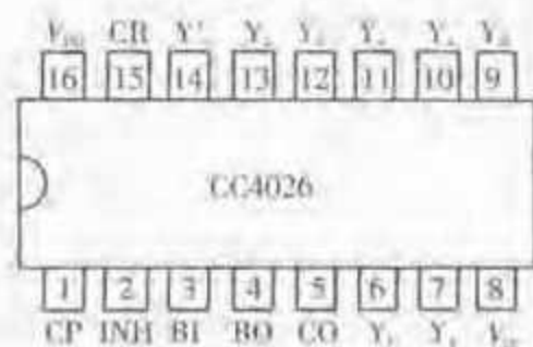
图 4-85 七段译码输出/十进制计数器 CC4026 型的引脚排列
