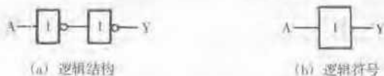
图 4-15 缓冲器的逻辑结构和逻辑符号
