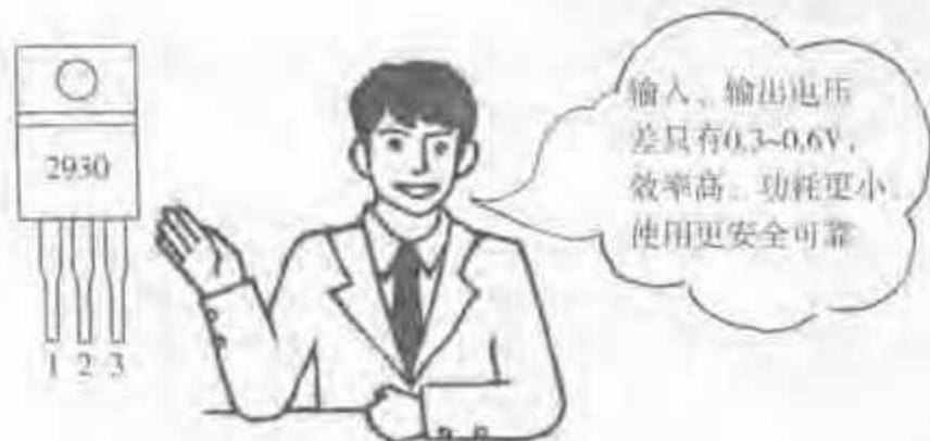
图 5-35 低压差集成稳压器的优点
