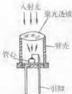
图 3-99 硅光敏二极管的基本构造
