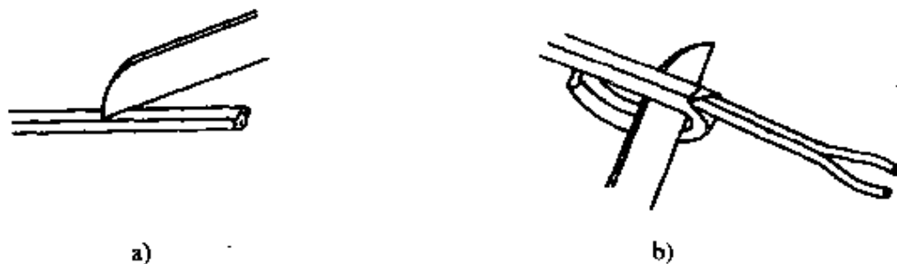
图 2-19 护套层的剥离方法
