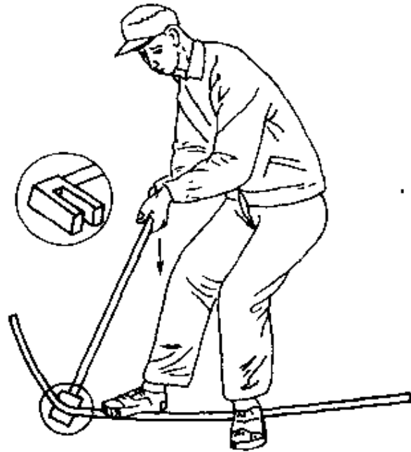
图 2-11 中、小型电线管的弯曲方法
