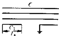
图 17-3 一根断线并接地
