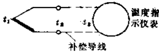
图 12-25 热电偶连接补偿导线的电路
