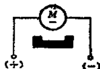
图 5-4 永磁直流电动机出线标志
