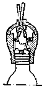
(b) 灯座中利用 软线打结的情形
