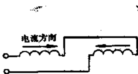
图5-17 二个电流方向相反绕组的连接
