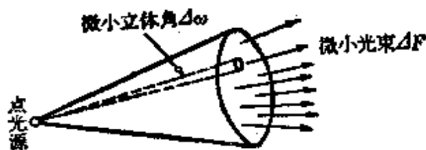
图 13.1 光束、立体角和发光强度的关系
