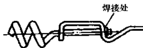
图 11-18 电热丝与引出带的焊接方法
