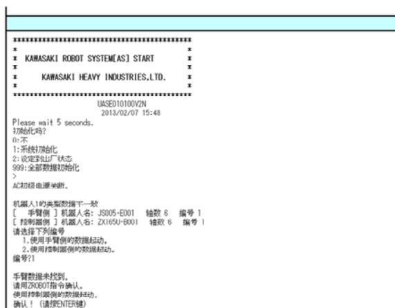
如果机器人机种不符合控制器和手臂之间的机种，而选择“手臂侧”启动时，则显示此画面。确认机器人机种设定。
