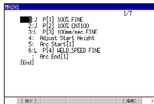
图 13.23.1(b) 使用了电弧开始高度自动调整功能的程序例
