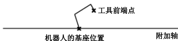
图 9.43.4 (a) 有附加轴时的对称移转
