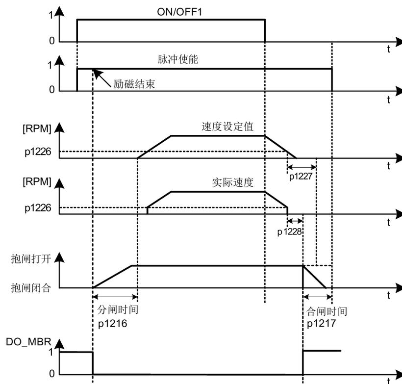
抱闸闭合时间从 p1227（静态监控时间）和 p1228（脉冲清除延时）其中一个较短的时间结束时开始计算。
