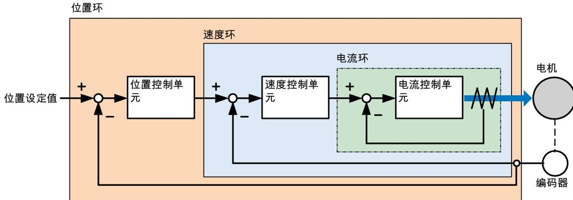
理论上，内部控制环的频宽**必须**比外部控制环的宽；否则，整个控制系统会振动或响应等级降低。上述三个控制环频宽之间的关系如下所示：
