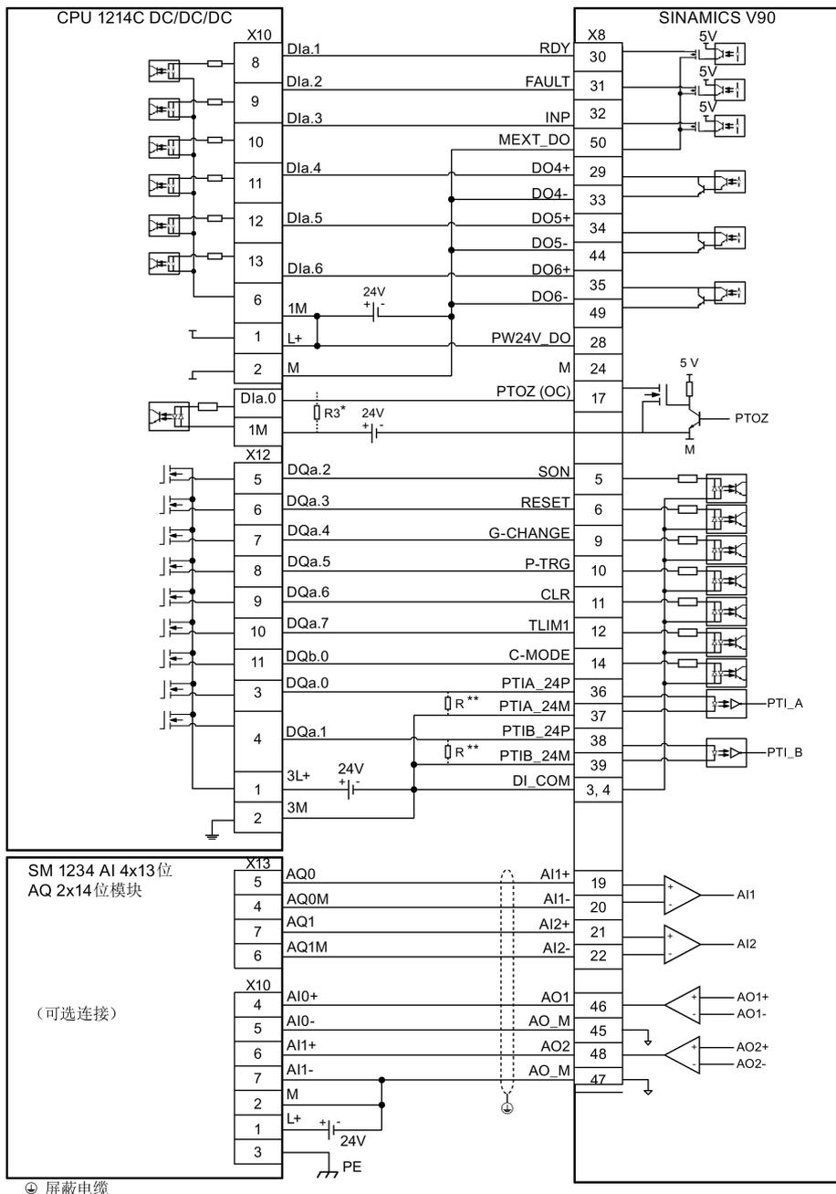
\* 只有当搜索零位速度超过 300 rpm 时，才需要电阻器 R3（200 Ohm 至 500 Ohm）。
