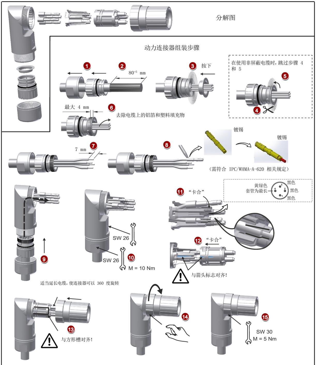
A.2 组装电机端的电缆连接器
