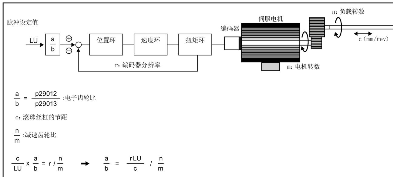
计算电子齿轮比的示例
