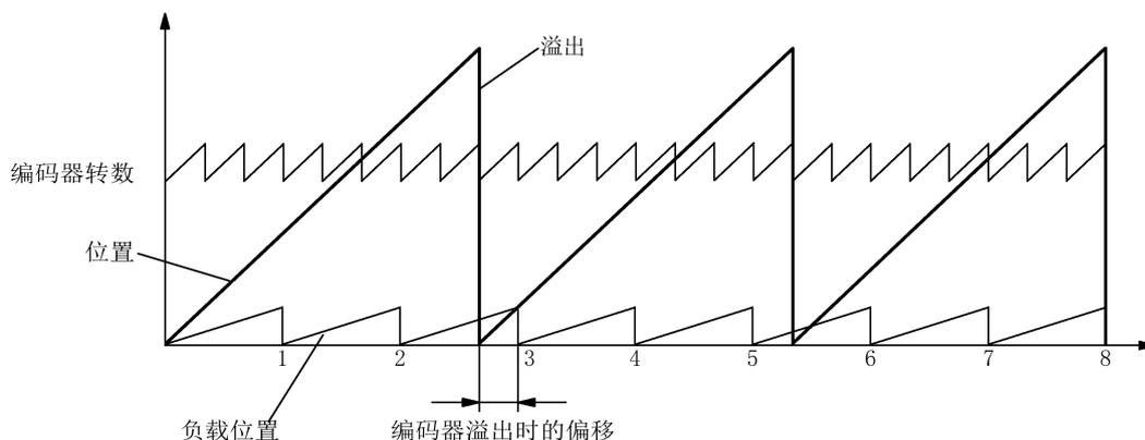
在这种情况下，编码器计数器每溢出一圈，负载便偏移 1/3 转，编码器溢出三圈后，电机和负载零位再次重叠。编码器溢出一圈后便不能再精确重复负载位置。
