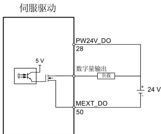
数字量输出 4 至 6 可支持 NPN 和 PNP 接线方式，如下图所示：
