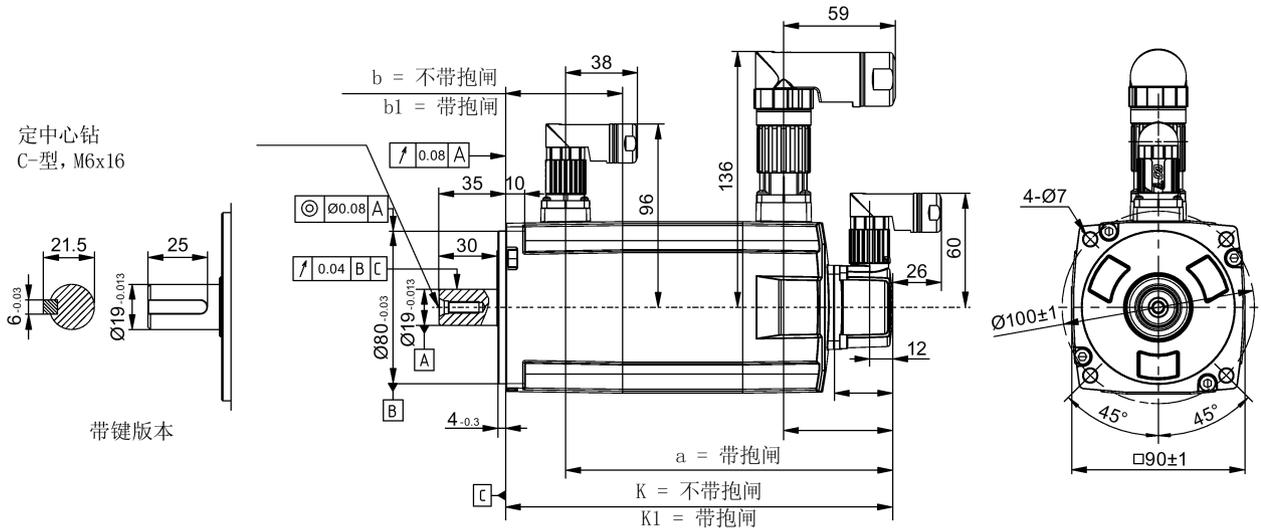
轴高 45 mm，带绝对值编码器和直角连接器
