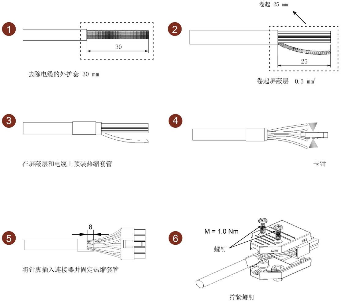
A.2 组装电机端的电缆连接器
