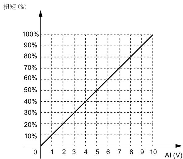
在此情况下，5 V 的模拟量输入对应额定扭矩的 50%，10 V 对应额定扭矩的 100%。
