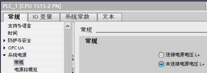
图 4-10 连接 PS 60W 24/48/60VDC HF
