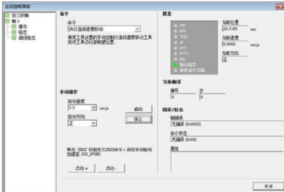
通过运动控制面板，可以对轴进行手动操作，设置目标速度后，执行命令，在状态中可以看到轴已组态，当前位置为 25.9182。还可以对轴进行一系列操作，查找参考点，连续移动等。在错误 / 状态中，可以看到命令出错的信息，极大的方便了现场调试的工程师。
