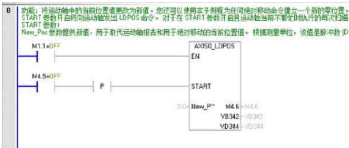
这是完整的程序, 可以看到轴正常控制, 可以手动 /自动、正反转运行, 设定距离及速度后能够到位停止, 第 8 网络则是对当前位置 0, 包络曲线运行也正常。在第 3 网络段可以看到当前位置。
