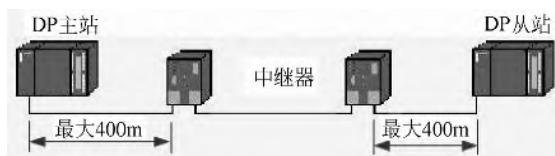
图 7-17 RS-485 中继器的拓扑结构
