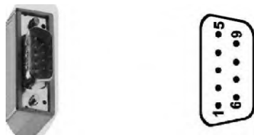
图 7-11 网络接头的外观与管脚定义
