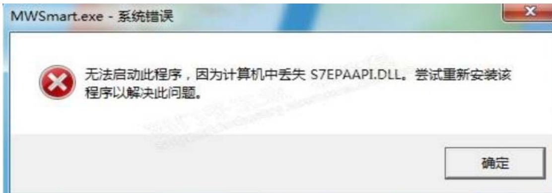
解决办法：这是软件安装的问题，你的电脑上安装了西门子的其他软件，如 STEP7，STEP7 MICROWIN 再安装 S7 SMART 会出现这种问题，因为安装不完全，中间跳过了驱动安装，解决办法是从 STEP7，或者 STEP7 MICROWIN 中复制一个，再重命名。
