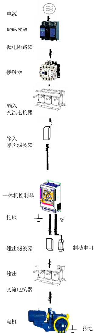
图 2-1 产品与外围器件的连接图
