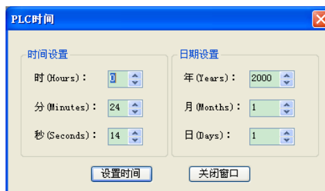
图2-20 设置 PLC 时间
