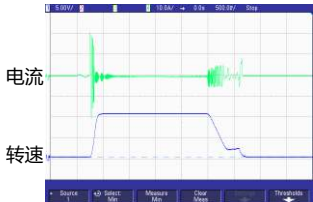
永磁同步电机短路制动波形，加速 时间0.1s，减速时间0.4s(电机额定 频率100Hz，短路制动频率20Hz， 制动时间0.5s)
