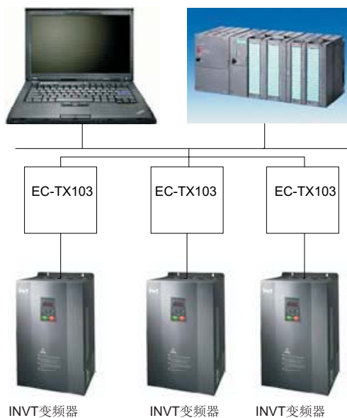
图7-20 Profibus 通讯结构图
