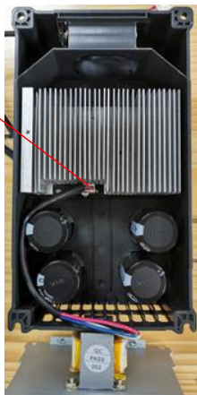
图 6-2 工频变压器拆卸示意图
