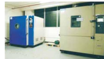
低气压测试箱(左), 恒温恒湿测试箱(右)
