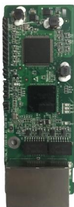
PROFINET 通讯卡 EC-TX509
