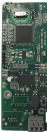
CANopen/CAN 主从 控制通讯卡 EC-TX505/511
