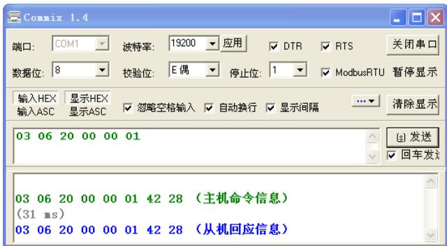
首先将“串口”选择 COM1。波特率要与 P14.01 设置一致。数据位、校验位、停止位一定要与 P14.02 中设置的一致。因为使用的是 RTU 模式, 所以选择十六进制的“HEX”。要软件自动加上 CRC, 一定要选上  ModbusRTU, 并且选择 CRC16(ModbusRTU), 起始字节为 1。一旦使能了自动加 CRC 校验, 在填指令时就不要再填 CRC 了, 否则会重复而导致指令错误。
