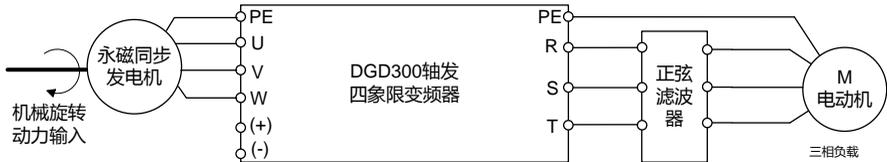
图 3.3 永磁同步电机配套三相三线负载主回路接线图
