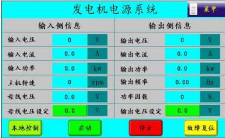
上图中左侧的输入侧是指发电机侧的运行数据，右侧的输出侧为逆变输出的运行数据，下方为客户操作界面。
